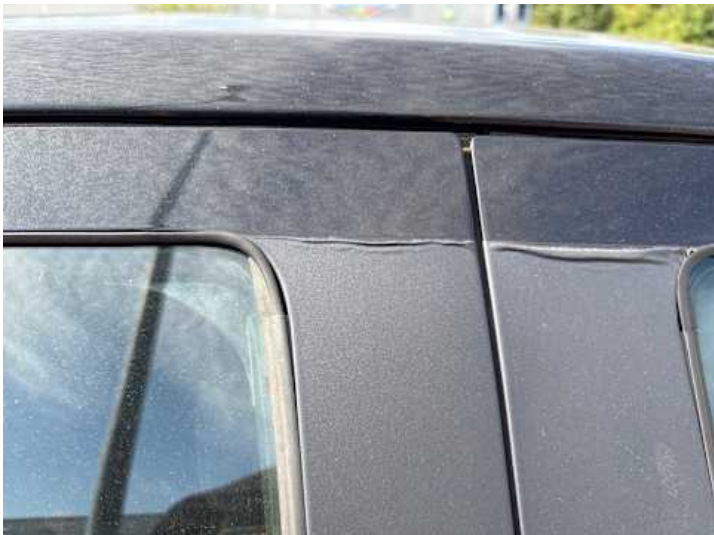
Türe hinten rechts (Anderer Schaden): Folie beschädigt
