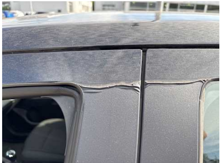
Fahrtür (Anderer Schaden): Folie beschädigt
