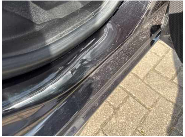
Schweller rechts (Kratzer)
