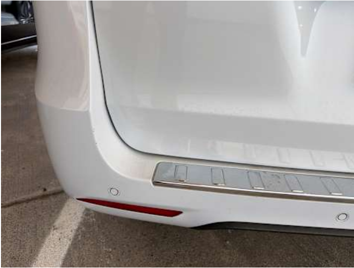
Stoßstange hinten (Lackschaden)
