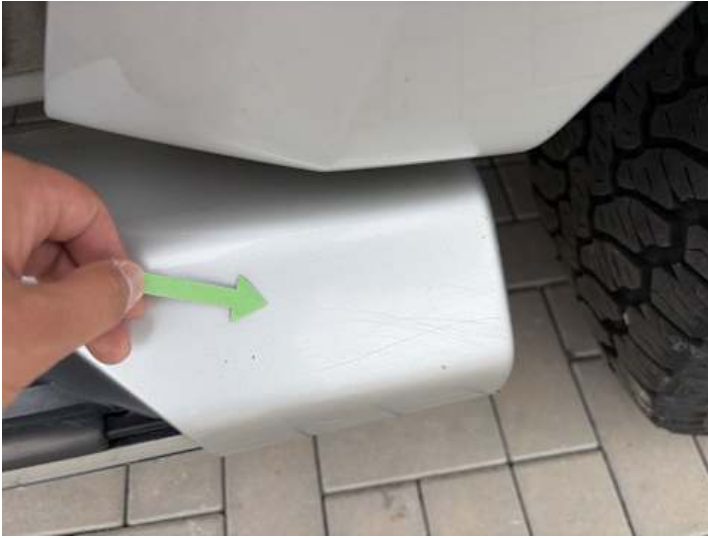
Schweller links (Kratzer)
