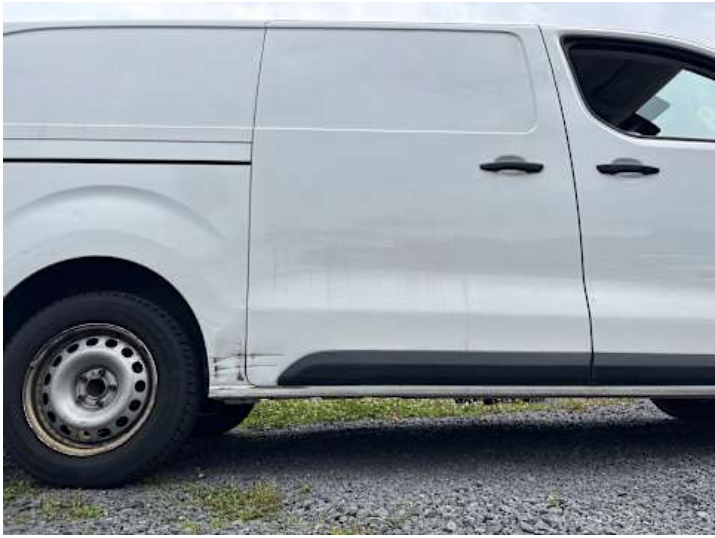
Seitenteil hinten rechts (Verformung, Kratzer)
