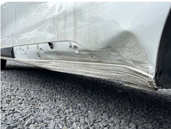
Schweller links (Verformung, Kratzer)
