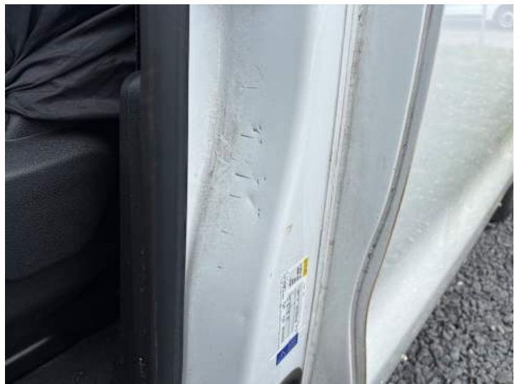
Schweller links (Delle, Kratzer)
