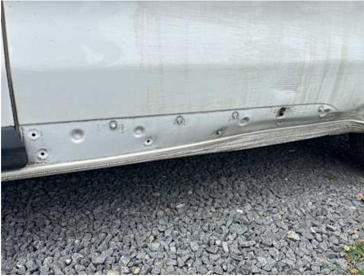
Seitenteil hinten links (Anderer Schaden): Verkleidung fehlt
