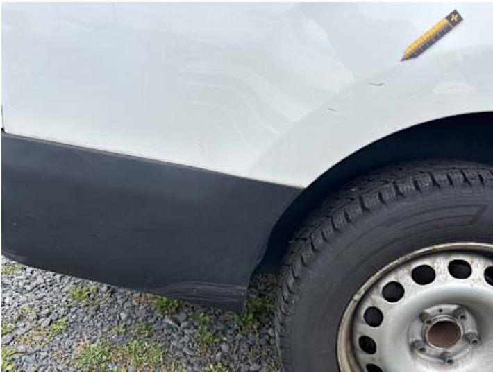
Seitenteil hinten rechts (Verformung, Kratzer)
