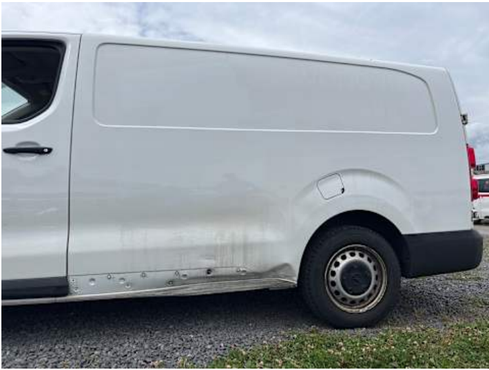
Seitenteil hinten links (Verformung, Kratzer)
