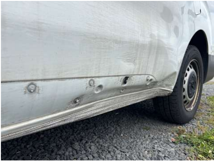
Seitenteil hinten links (Verformung, Kratzer)
