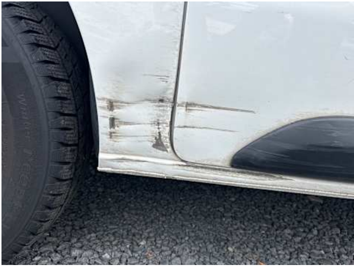
Seitenteil hinten rechts (Verformung, Kratzer)
