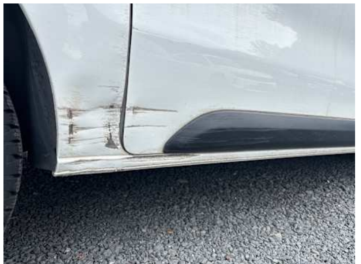
Schweller rechts (Verformung, Kratzer)
