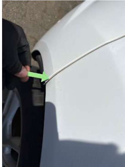
Stoßstange hinten (Spaltmaße ungenau)
