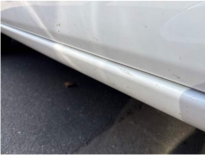
Schweller links (Kratzer)
