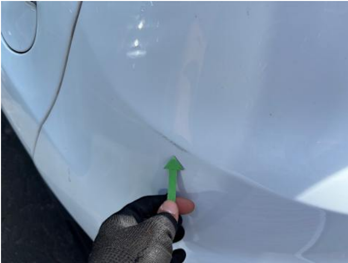
Stoßstange hinten (Kratzer)
