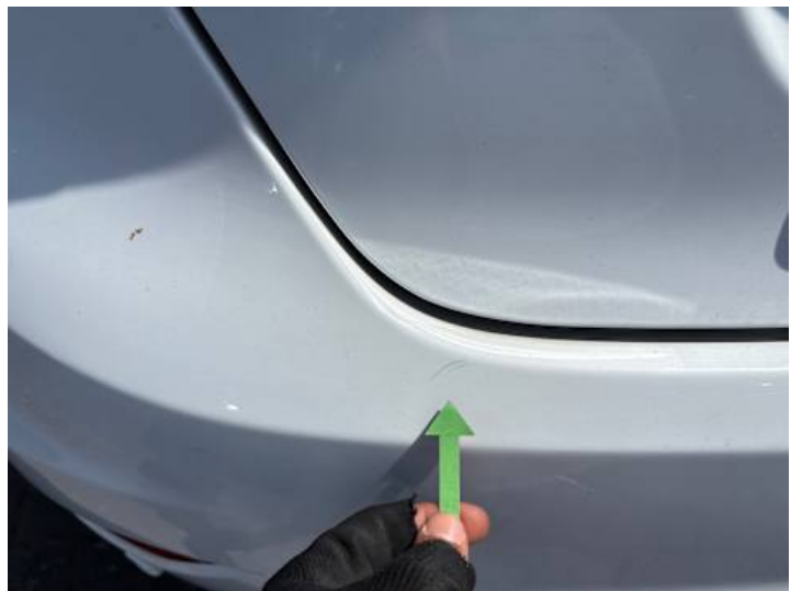
Stoßstange hinten (Kratzer)
