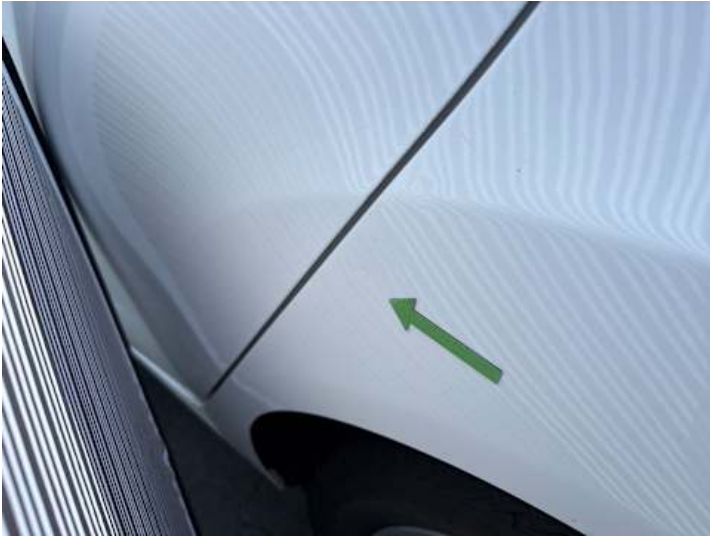
Seitenteil hinten links (Delle)
