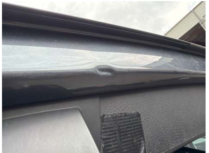
Heckklappe (Riss/Bruch, Delle)
