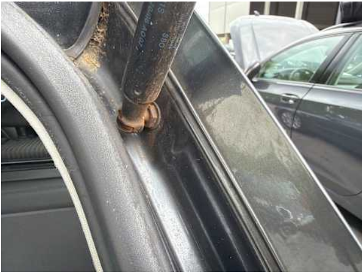
Heckklappe (Riss/Bruch, Delle)
