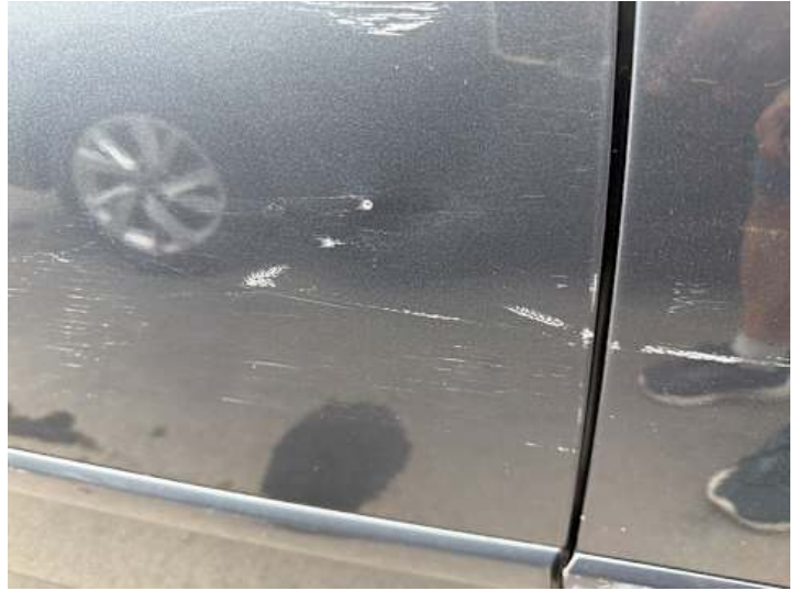
Türe hinten rechts (Kratzer, Lackschaden, Delle)
