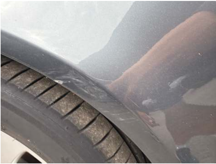
Kotflügel vorne rechts (Rost, Lackschaden)
