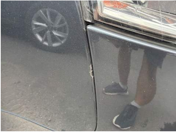
Kotflügel vorne rechts (Rost, Lackschaden)
