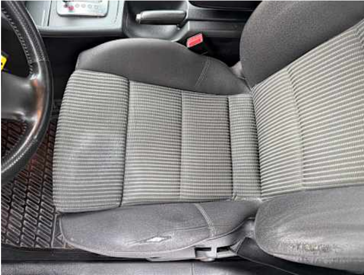
Innenraum (Verschmutzung, Verschleiß, Riss/Bruch)
