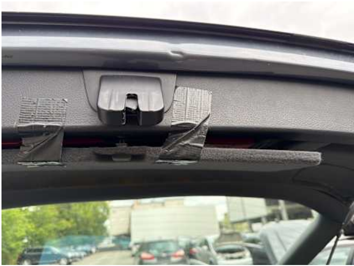
Heckklappe (Riss/Bruch, Delle)
