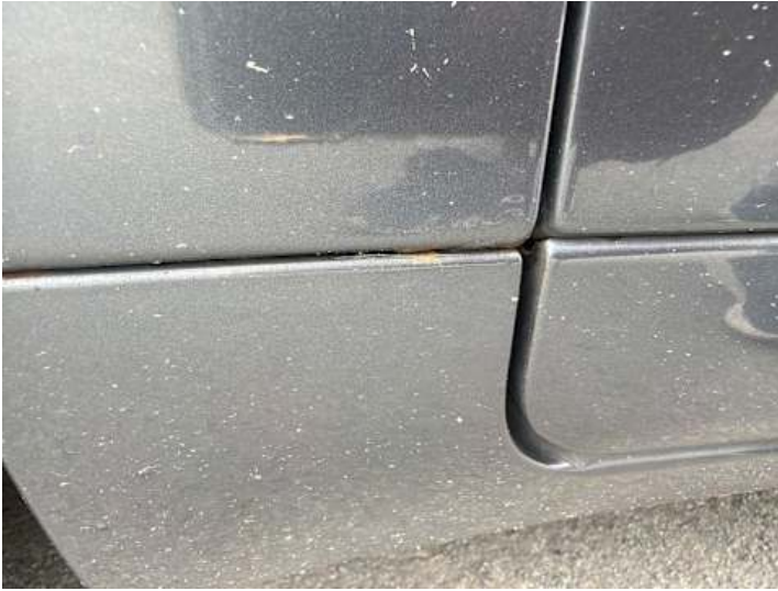
Schweller links (Rost)
