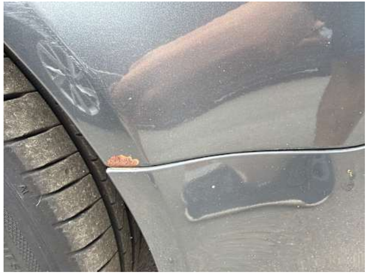
Kotflügel vorne rechts (Rost, Lackschaden)
