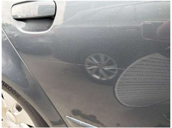
Türe hinten rechts (Kratzer, Lackschaden, Delle)
