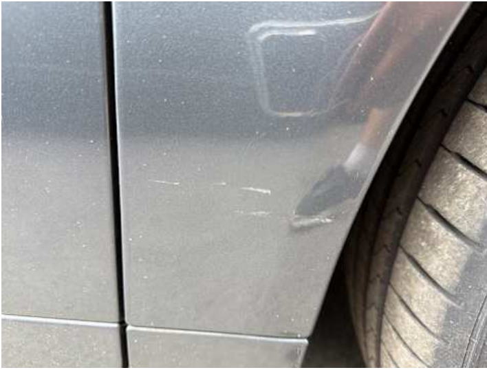
Kotflügel vorne rechts (Rost, Lackschaden)
