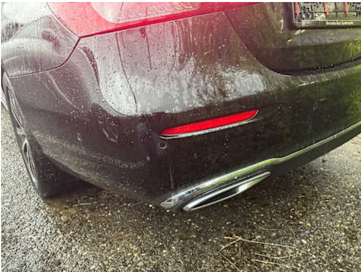
Stoßstange hinten (Kratzer, Lackschaden)
