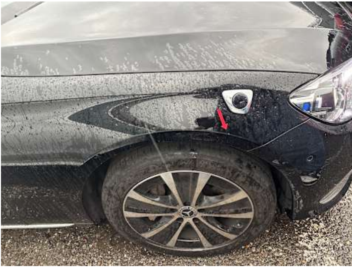
Kotflügel vorne rechts (Lackschaden)
