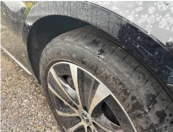
Rad (Ungleichmäßig abgefahren)
