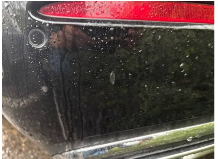
Stoßstange hinten (Kratzer, Lackschaden)
