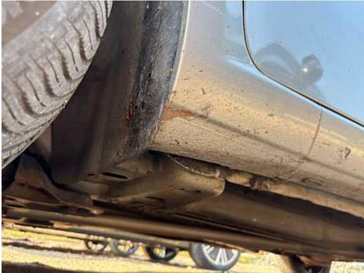
Kotflügel vorne links (Rost)
