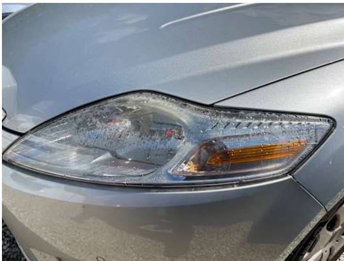
Scheinwerfer (links) (Undicht)
