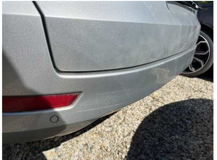
Stoßstange hinten (Verformung, Kratzer)
