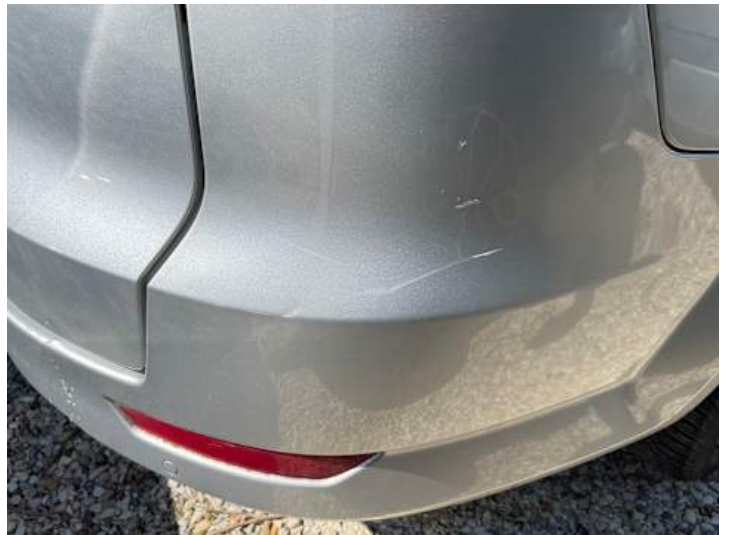
Stoßstange hinten (Verformung, Kratzer)
