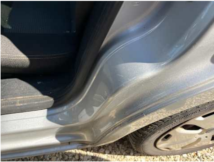
Schweller links (Kratzer, Delle)
