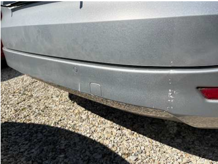
Stoßstange hinten (Verformung, Kratzer)
