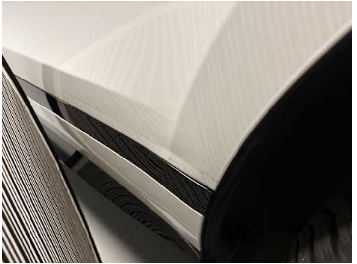
Türe hinten links (Kratzer, Delle)
