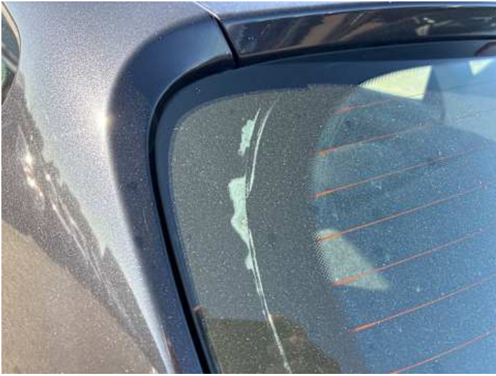
Rückscheibe (Anderer Schaden): Zieht Luft
