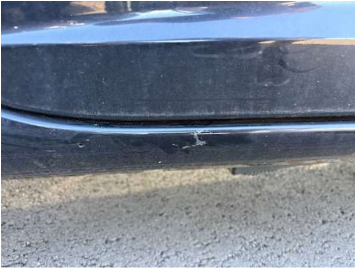
Schweller rechts (Lackschaden)
