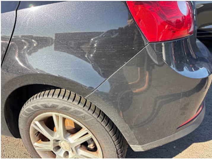
Stoßstange hinten (Anderer Schaden): Farbunterschied
