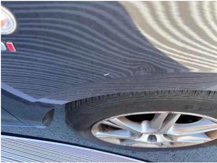
Kotflügel vorne rechts (Delle, Kratzer)
