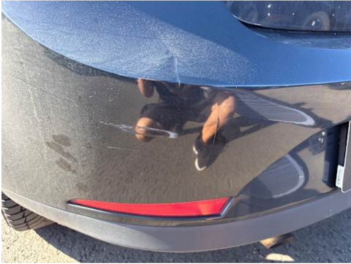
Stoßstange hinten (Kratzer, Verformung, Lackschaden)
