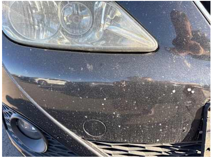
Stoßstange vorne (Steinschlag, Lackschaden)
