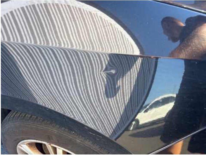
Kotflügel vorne rechts (Delle, Kratzer)
