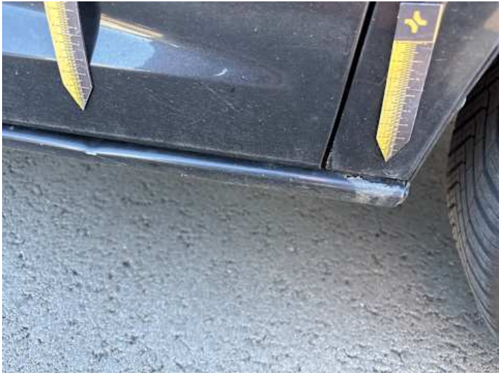
Schweller rechts (Kratzer, Verformung)
