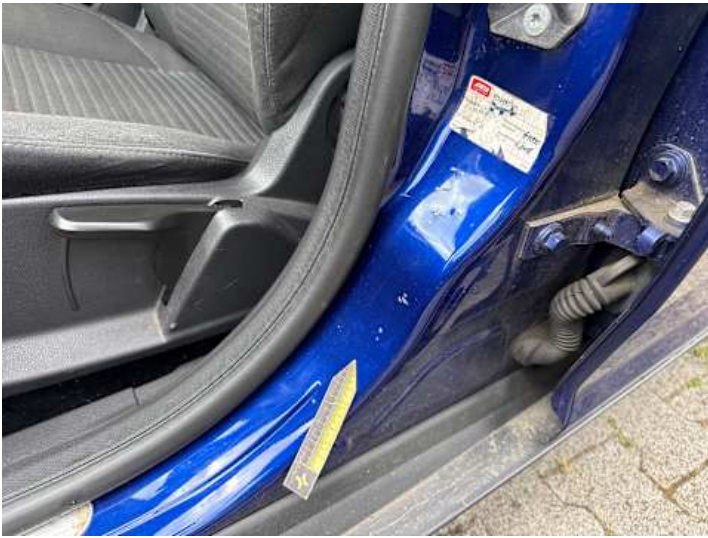
Schweller links (Kratzer, Delle)
