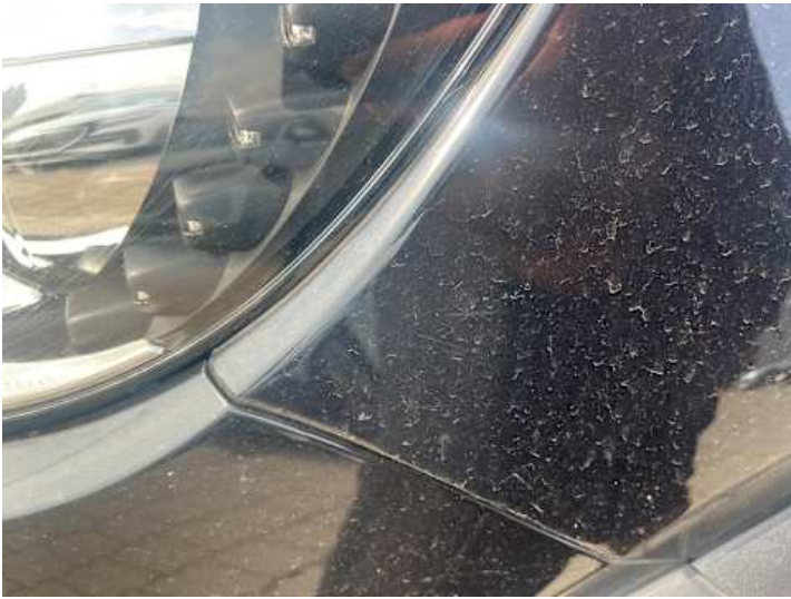
Kotflügel vorne links (Kratzer, Lackschaden)
