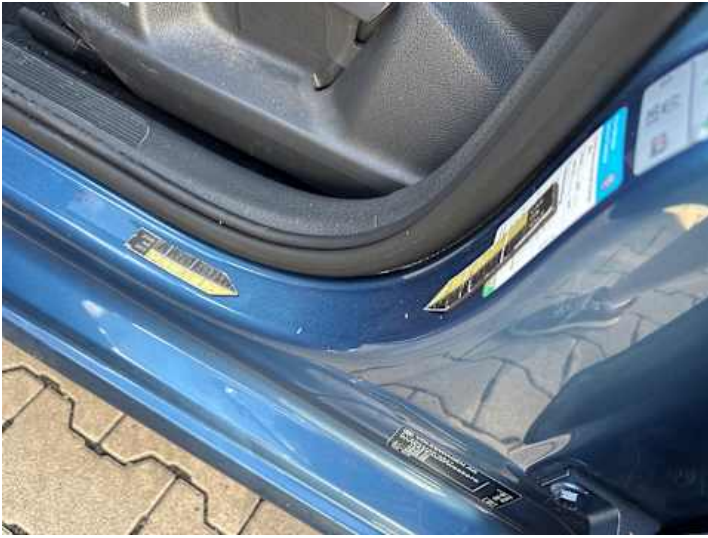
Schweller links (Delle, Kratzer)
