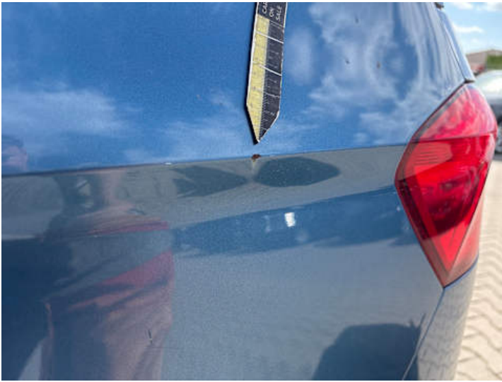
Seitenteil hinten links (Rost, Lackschaden)
