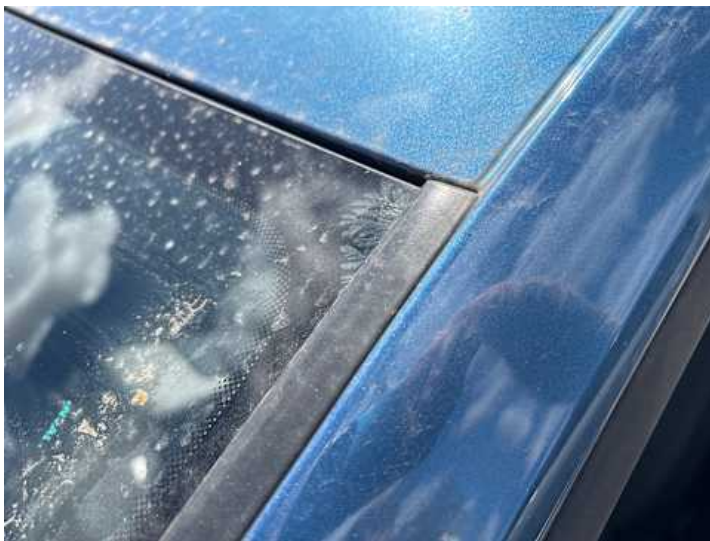
Windschutzscheibe (Anderer Schaden): Kleber löst sich
