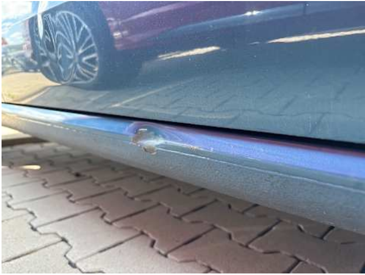
Schweller rechts (Verformung, Rost, Lackschaden)
