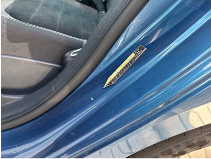
Schweller links (Delle, Kratzer)
