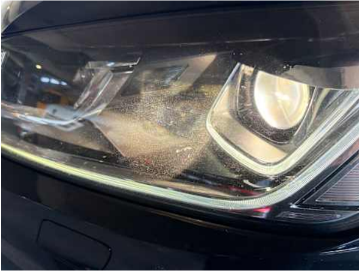
Scheinwerfer (links) (Kratzer, Steinschlag)
