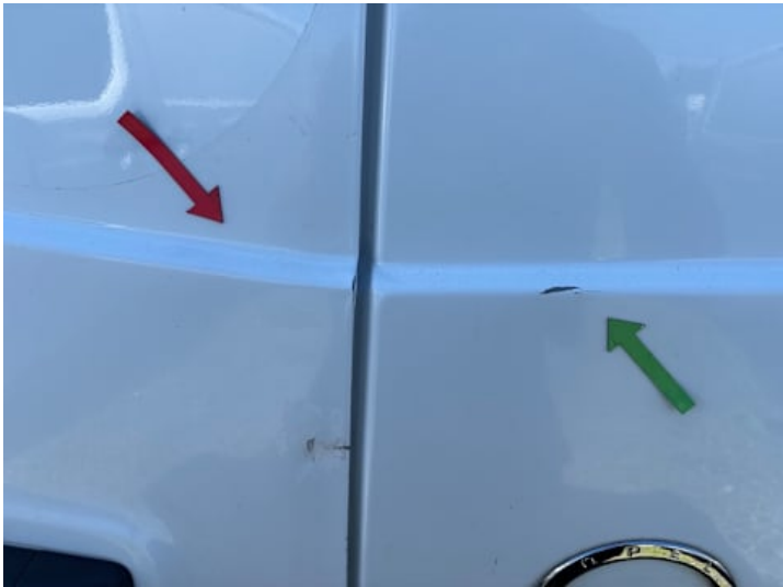
Heckklappe (Lackschaden, Delle)
