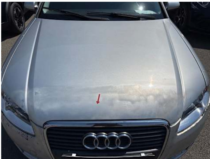
Motorhaube (Kratzer, Lackschaden, Ausgeblichen/Matt)
