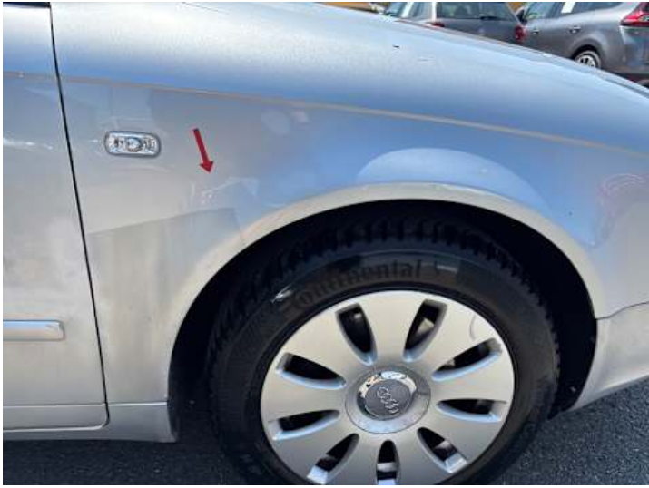
Kotflügel vorne rechts (Kratzer, Lackschaden, Ausgeblichen/Matt)
