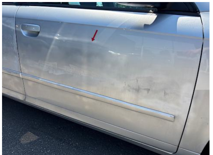
Beifahrertür (Kratzer, Lackschaden, Ausgeblichen/Matt)
