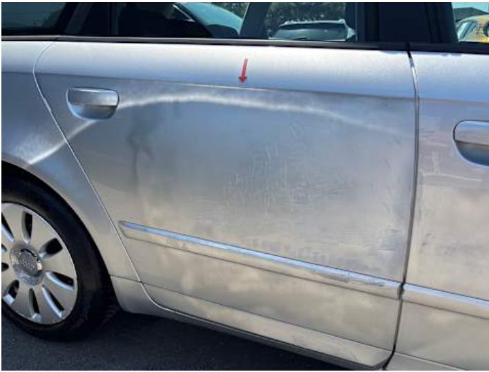
Türe hinten rechts (Kratzer, Lackschaden, Ausgeblichen/Matt)
