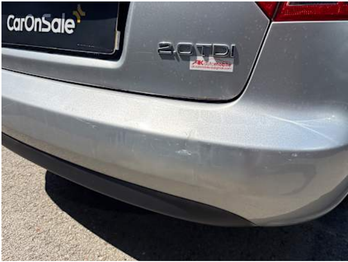
Stoßstange hinten (Kratzer, Lackschaden, Ausgeblichen/Matt)
