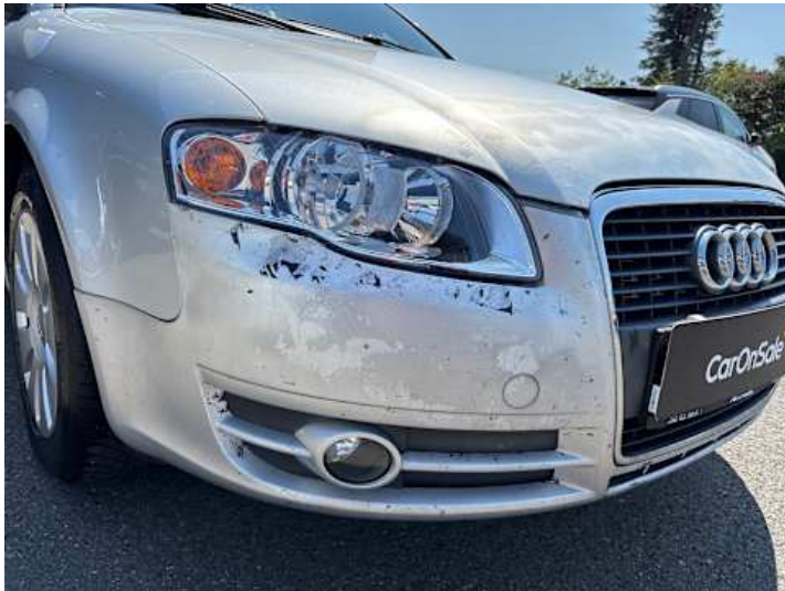
Stoßstange vorne (Kratzer, Lackschaden, Riss/Bruch)
