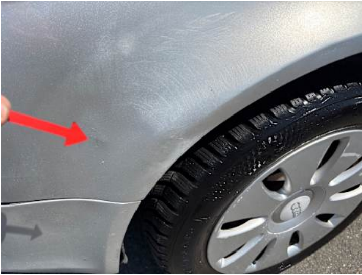
Kotflügel vorne links (Kratzer, Lackschaden, Verformung)
