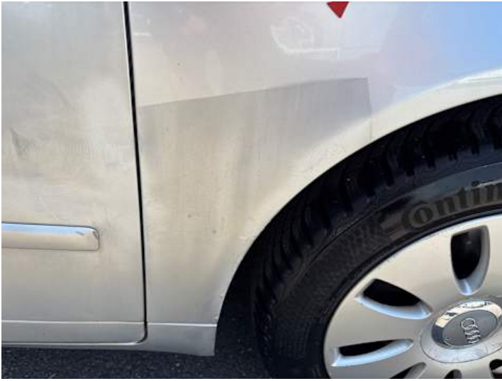
Kotflügel vorne rechts (Kratzer, Lackschaden, Ausgeblichen/Matt)
