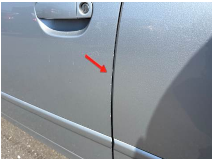
Fahrtür (Kratzer, Lackschaden)
