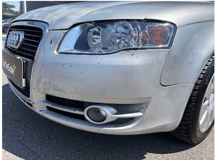
Stoßstange vorne (Kratzer, Lackschaden, Riss/Bruch)
