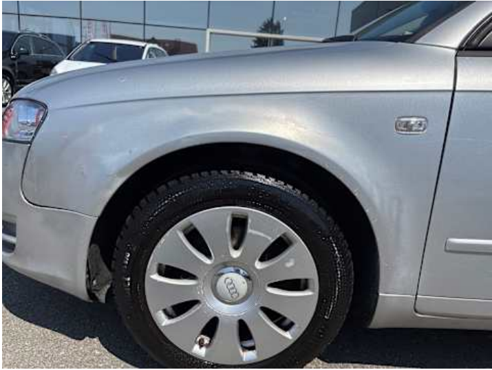
Kotflügel vorne links (Kratzer, Lackschaden, Verformung)
