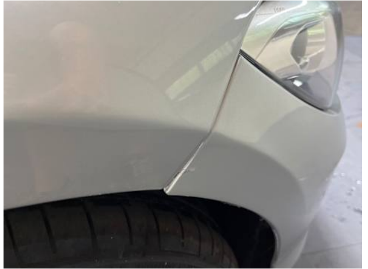
Stoßstange vorne (Spaltmaße ungenau, Lackschaden, Riss/Bruch)
