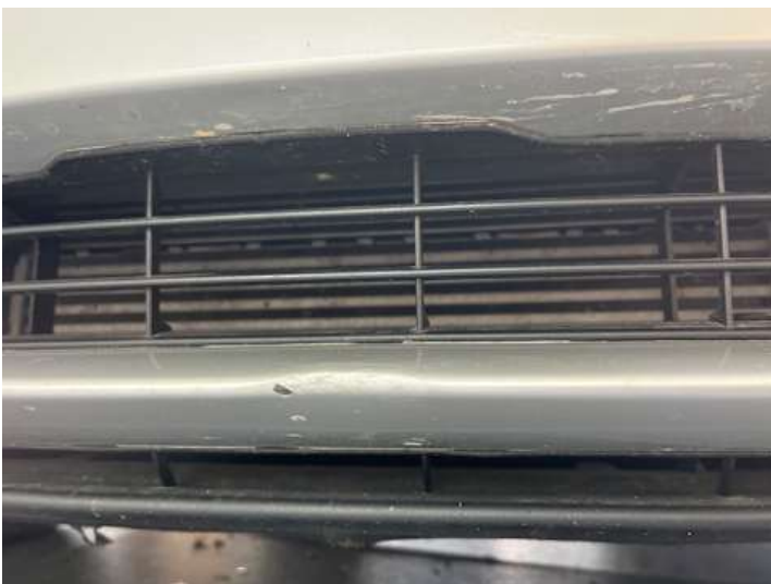
Stoßstange vorne (Verformung, Kratzer, Lackschaden)
