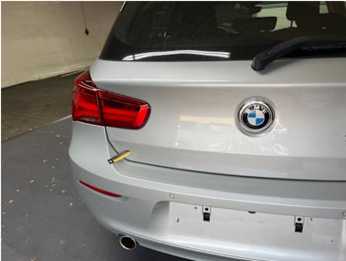
Heckklappe (Delle, Lackschaden)
