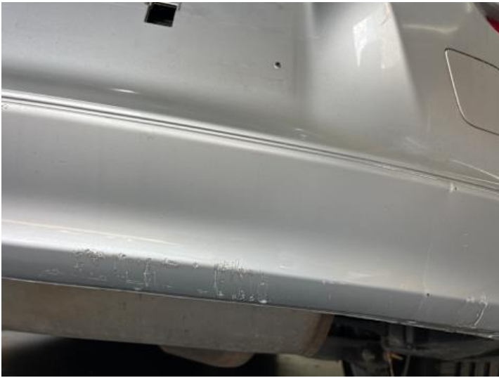
Stoßstange hinten (Ausgeblichen/Matt, Lackschaden, Kratzer)
