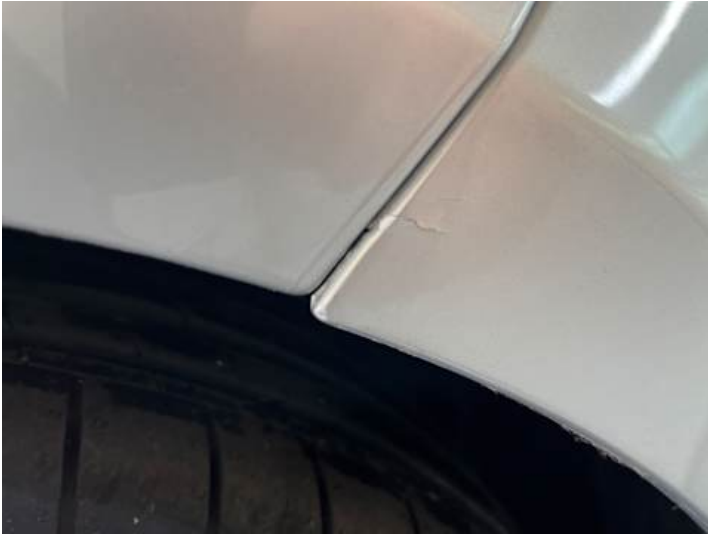
Stoßstange vorne (Spaltmaße ungenau, Lackschaden, Riss/Bruch)
