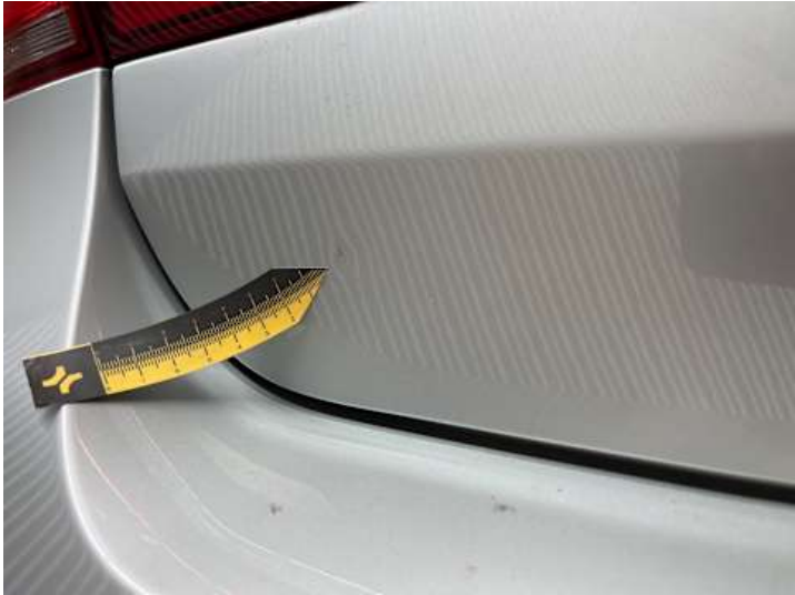
Heckklappe (Delle, Lackschaden)
