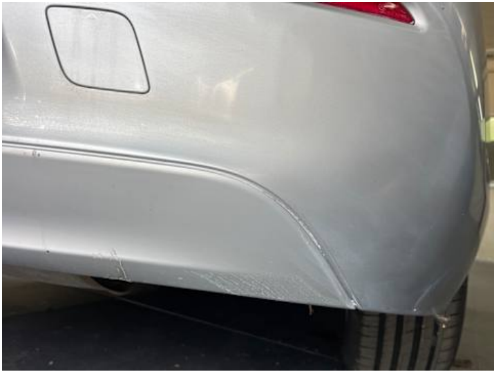
Stoßstange hinten (Ausgeblichen/Matt, Lackschaden, Kratzer)
