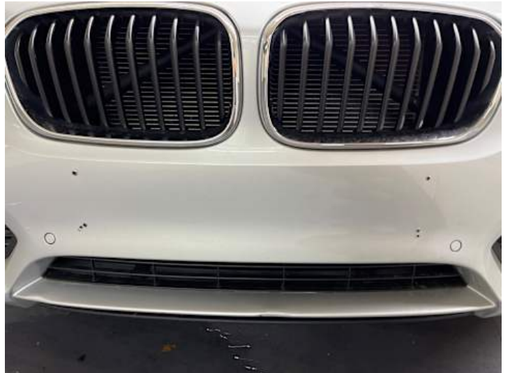
Stoßstange vorne (Verformung, Kratzer, Lackschaden)
