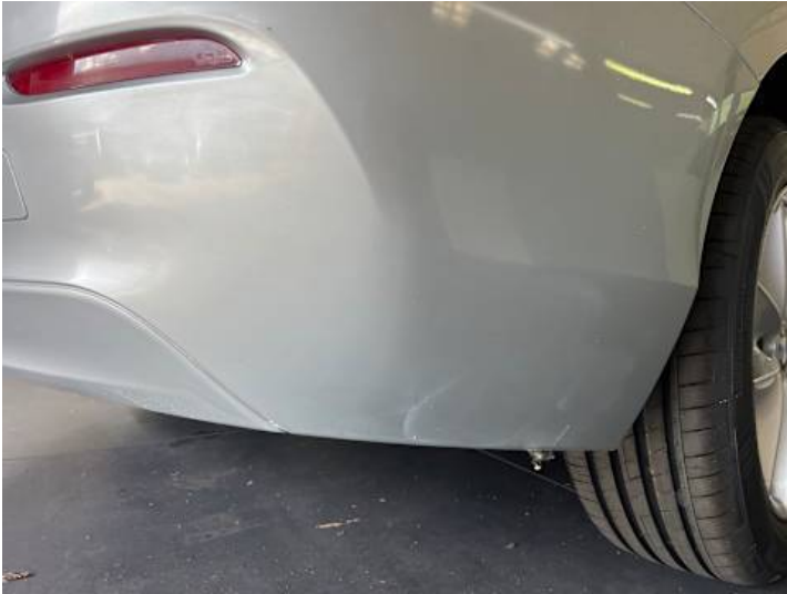
Stoßstange hinten (Ausgeblichen/Matt, Lackschaden, Kratzer)
