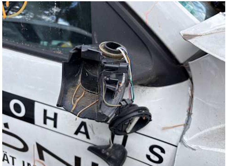
Beifahrtür (Lackschaden, Riss/Bruch)
