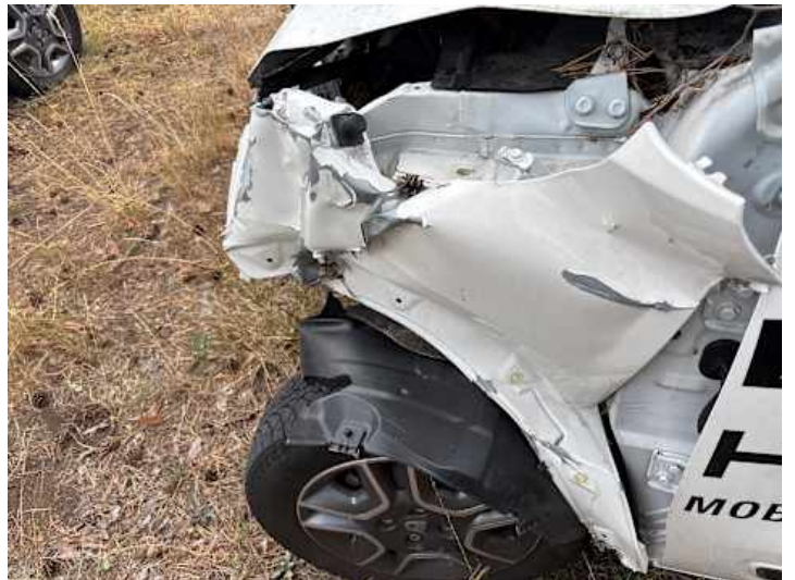
Kotflügel vorne links (Verformung, Riss/Bruch)
