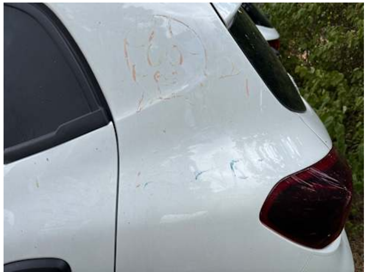
Seitenteil hinten links (Lackschaden)
