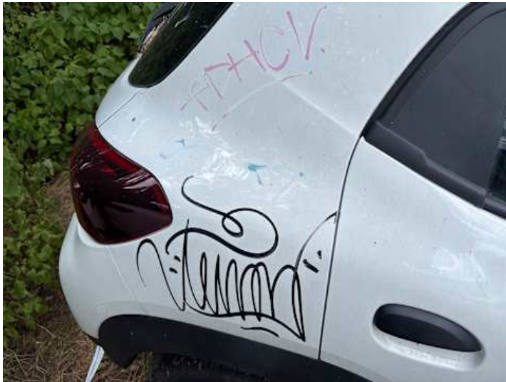
Seitenteil hinten rechts (Lackschaden)
