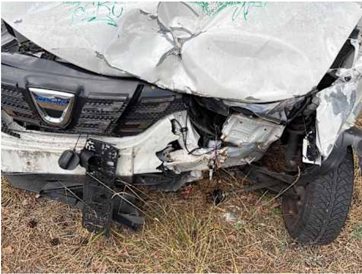
Stoßstange vorne (Riss/Bruch)
