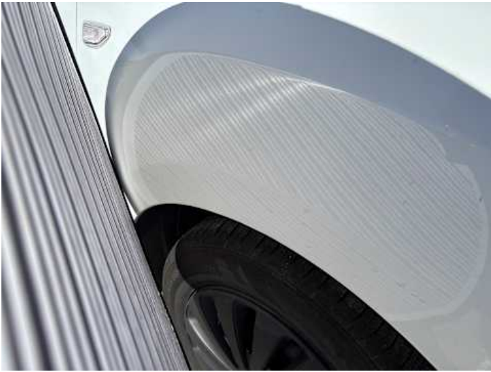
Kotflügel vorne rechts (Verformung)
