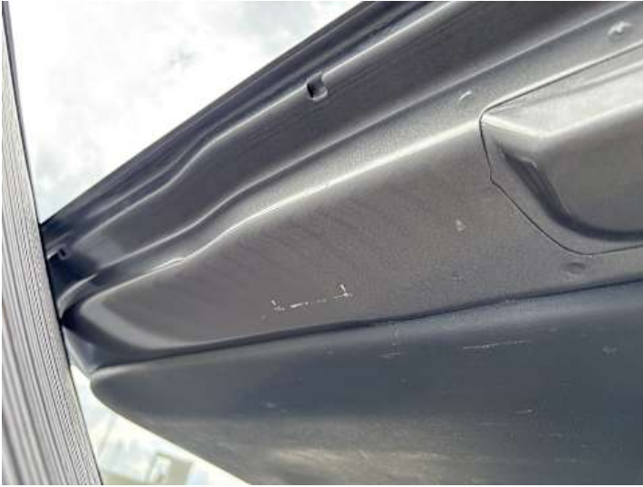
Heckklappe (Delle, Kratzer)
