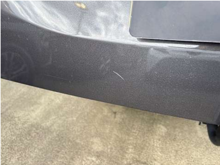
Heckklappe (Delle, Kratzer)
