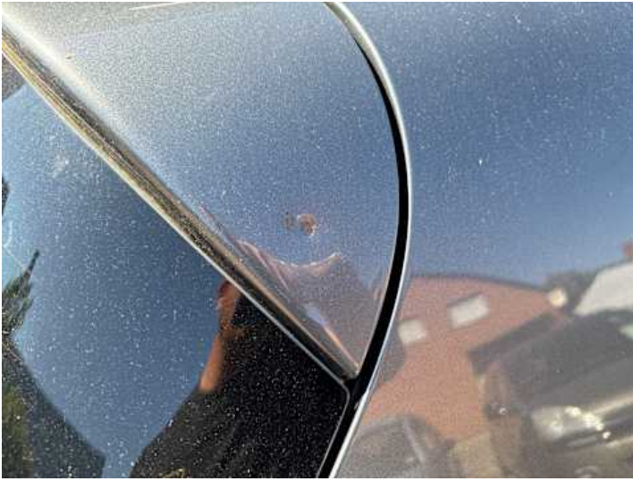
Heckklappe (Lackschaden, Delle)
