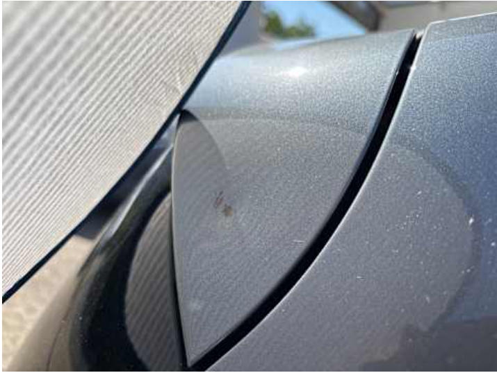
Heckklappe (Lackschaden, Delle)
