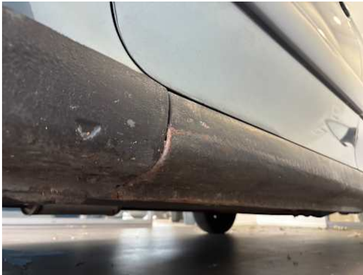
Schweller links (Unsachgemäß instand gesetzt, Rost, Lackschaden)
