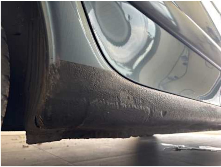
Schweller rechts (Rost, Lackschaden, Unsachgemäß instand gesetzt, Delle)
