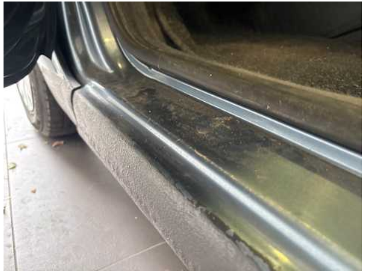
Schweller links (Delle, Lackschaden)
