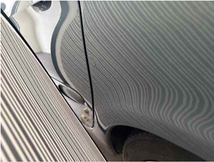
Seitenteil hinten links (Lackschaden, Delle)
