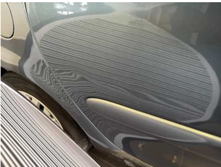
Türe hinten rechts (Verformung)
