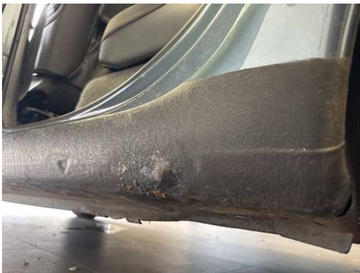
Schweller links (Lackschaden, Delle, Rost, Unsachgemäß instand gesetzt)
