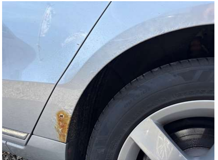
Seitenteil hinten links (Rost)
