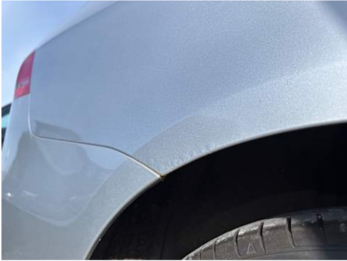
Seitenteil hinten rechts (Rost)
