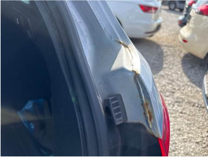
Seitenteil hinten rechts (Rost)
