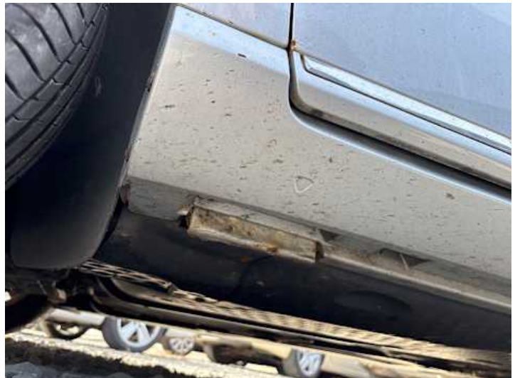
Schweller links (Rost)
