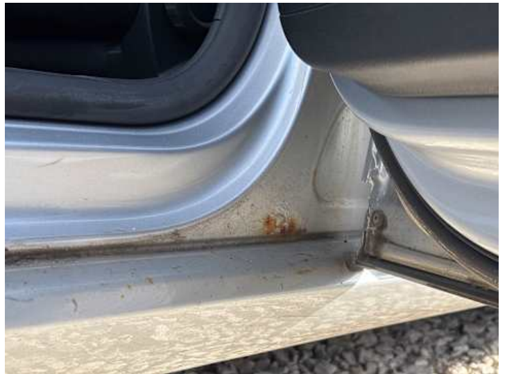
Türe hinten rechts (Rost)
