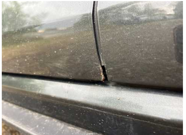
Fahrertür (Lackschaden, Rost)
