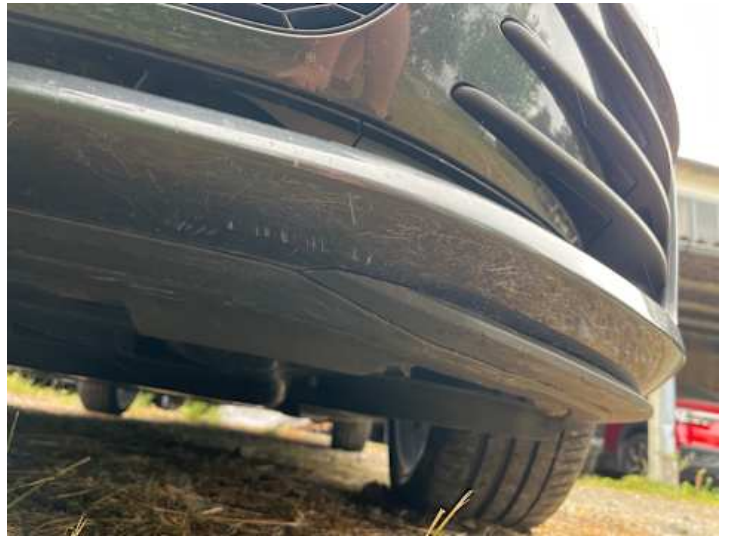
Stoßstange vorne (Kratzer, Lackschaden)
