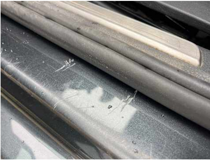
Schweller links (Lackschaden, Kratzer)
