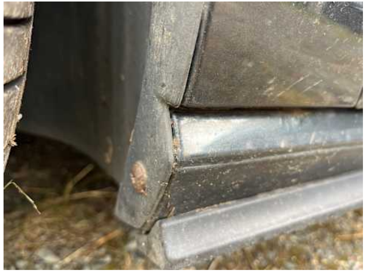
Schweller links (Rost)
