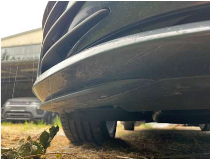
Stoßstange vorne (Kratzer, Lackschaden)
