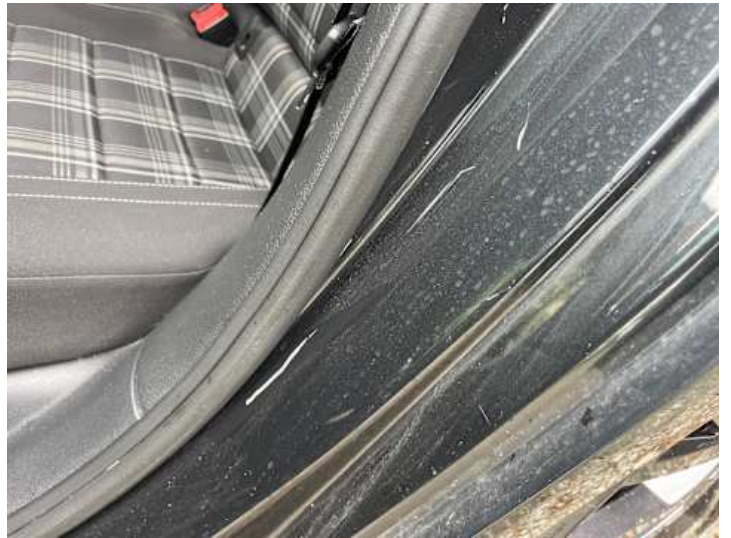
Seitenteil hinten links (Lackschaden, Kratzer)
