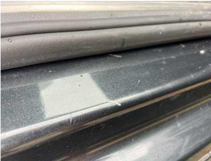
Schweller rechts (Lackschaden, Kratzer)
