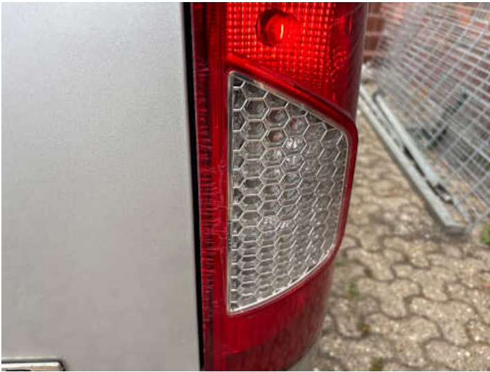
Rücklicht (rechts) (Riss/Bruch)
