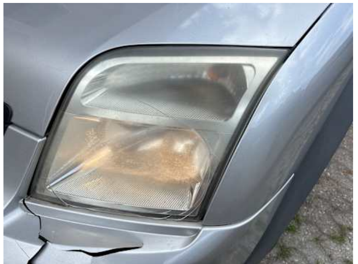
Scheinwerfer (links) (Riss/Bruch, Blind)
