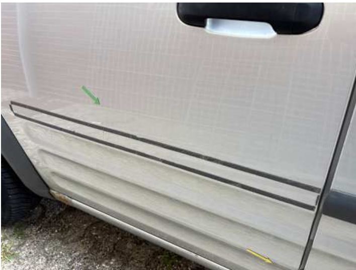
Türe hinten rechts (Anderer Schaden): Leiste fehlt
