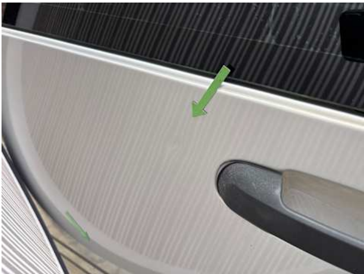
Türe hinten rechts (Delle)
