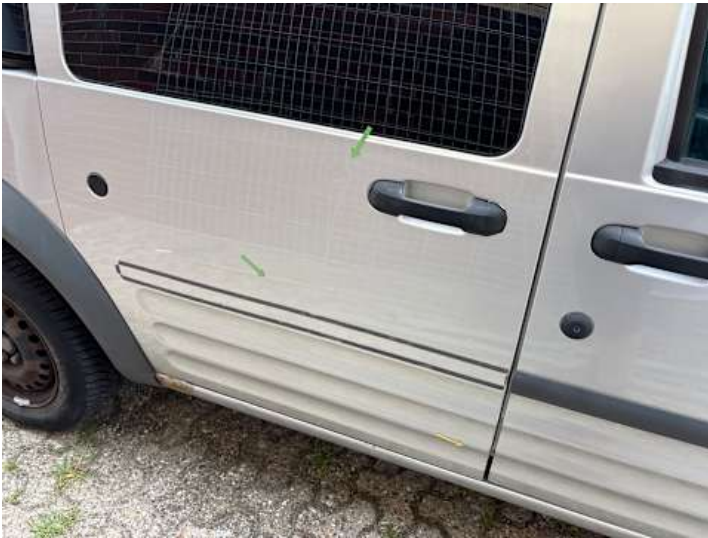
Türe hinten rechts (Lackschaden, Delle, Anderer Schaden): Leiste fehlt
