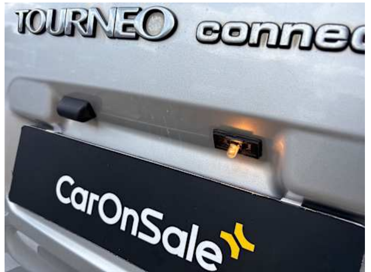
Heckklappe (Anderer Schaden): Abdeckung fehlt
