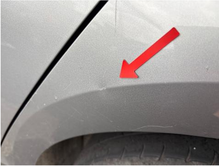
Seitenteil hinten links (Delle, Kratzer)
