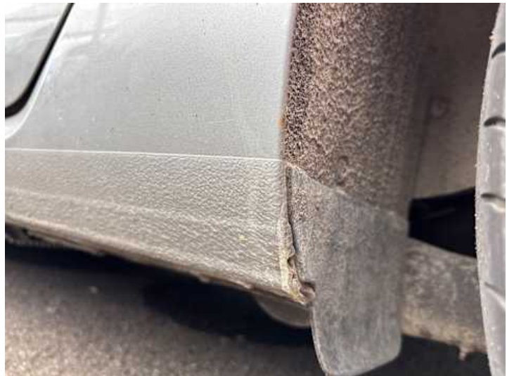
Schweller links (Rost)
