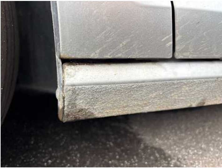
Schweller links (Rost)
