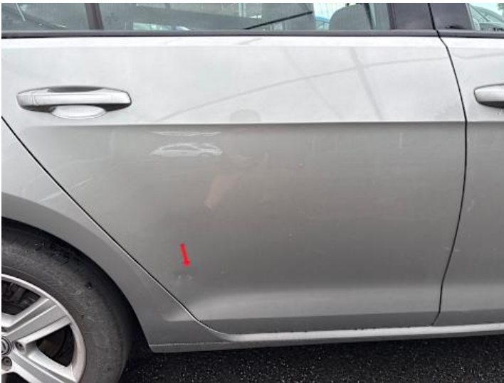
Türe hinten rechts (Kratzer, Verformung)
