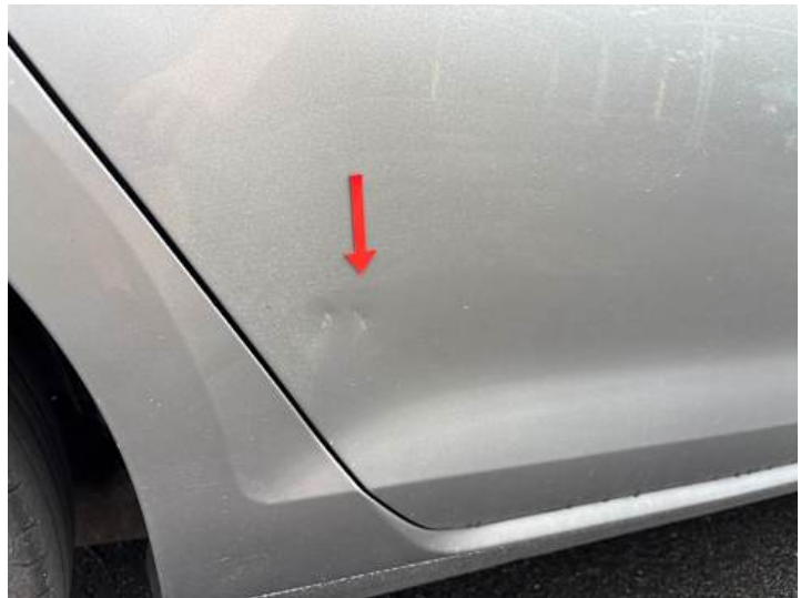
Türe hinten rechts (Kratzer, Verformung)
