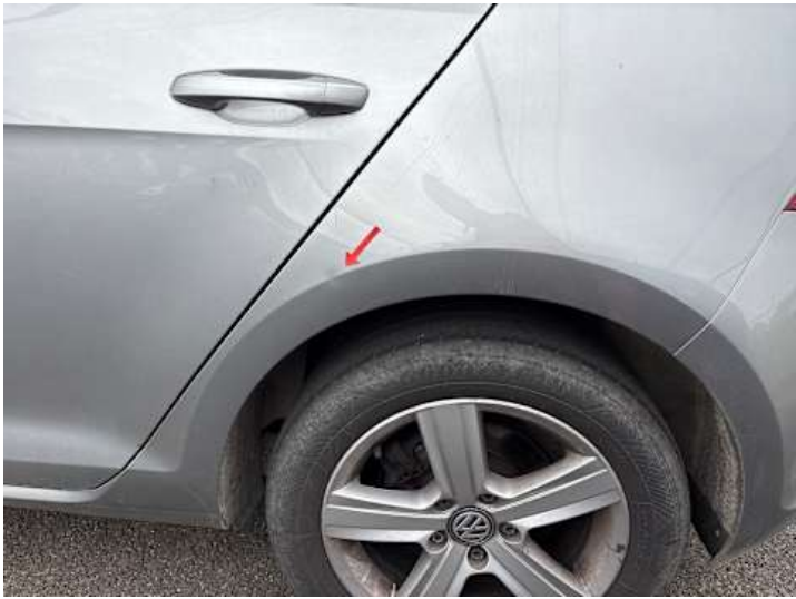
Seitenteil hinten links (Delle, Kratzer)
