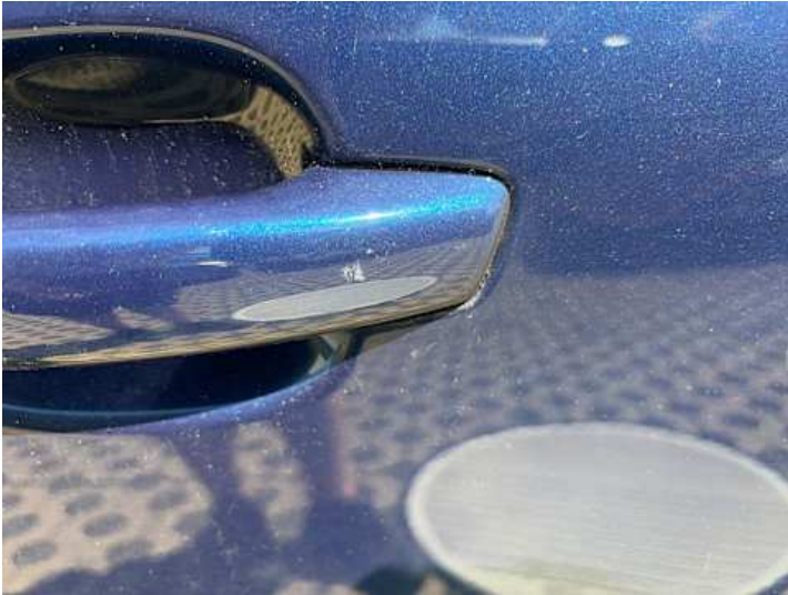
Beifahrtür (Kratzer, Lackschaden)
