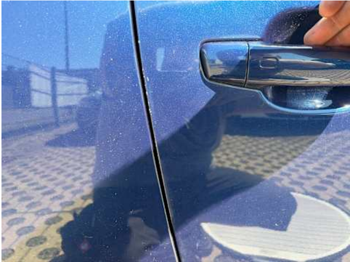
Beifahrtür (Kratzer, Lackschaden)
