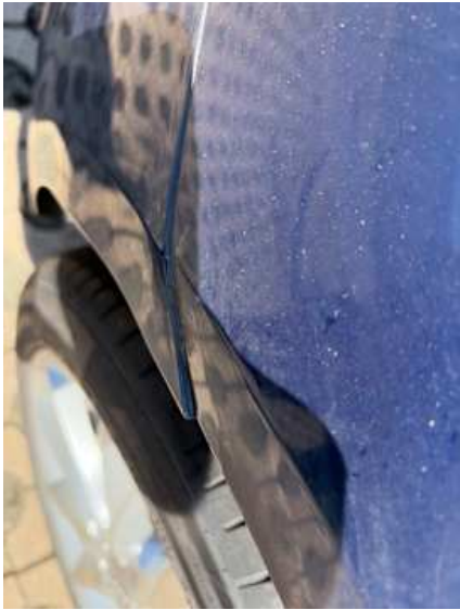
Stoßstange hinten (Spaltmaße ungenau)
