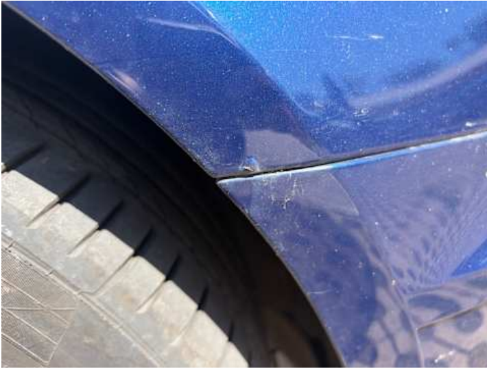
Kotflügel vorne rechts (Rost, Lackschaden)
