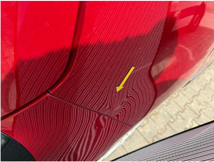
Seitenteil hinten rechts (Verformung)
