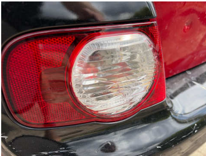
Rücklicht (links) (Riss/Bruch)
