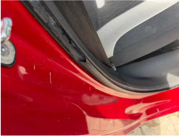
Türe hinten rechts (Kratzer, Delle)
