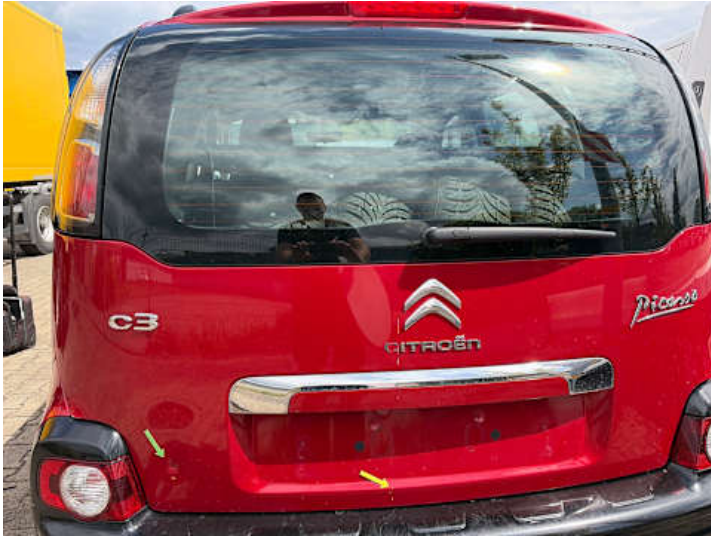
Heckklappe (Delle, Kratzer)
