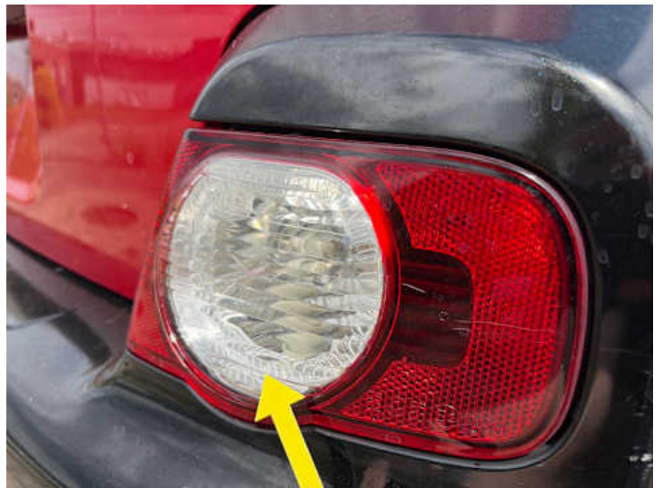
Rücklicht (rechts) (Riss/Bruch)
