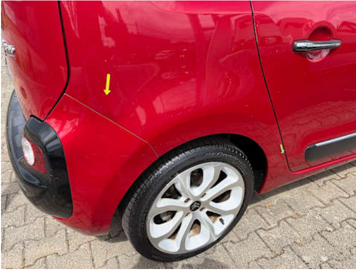
Seitenteil hinten rechts (Verformung, Delle)
