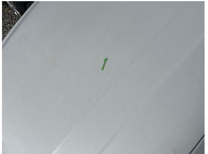
Motorhaube (Kratzer, Lackschaden)
