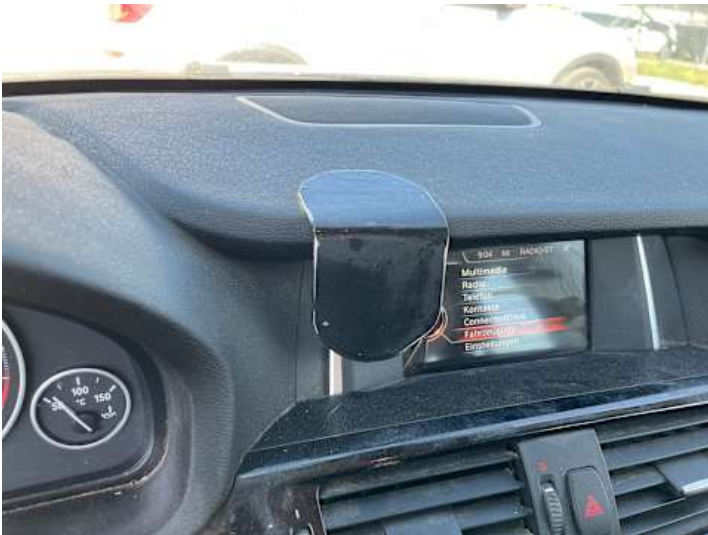
Innenraum (Anderer Schaden): Klebereste
