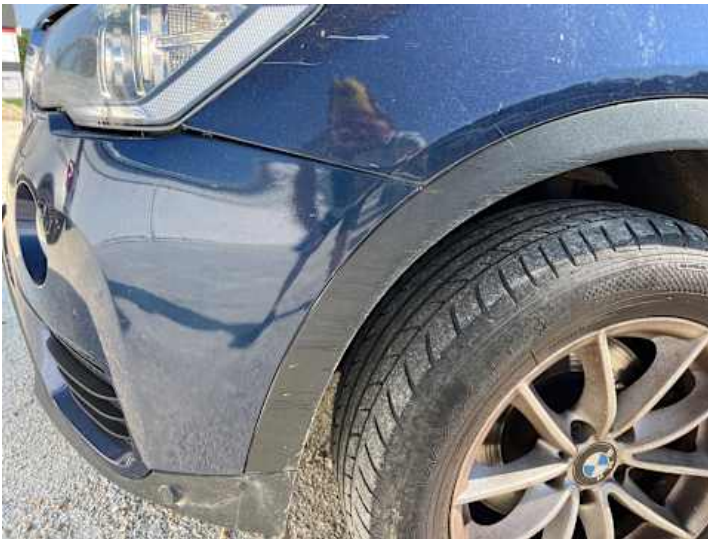
Stoßstange vorne (Kratzer, Spaltmaße ungenau)
