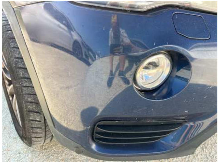
Stoßstange vorne (Kratzer, Spaltmaße ungenau)
