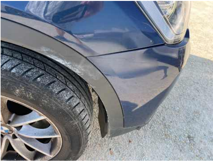
Stoßstange vorne (Kratzer, Spaltmaße ungenau)
