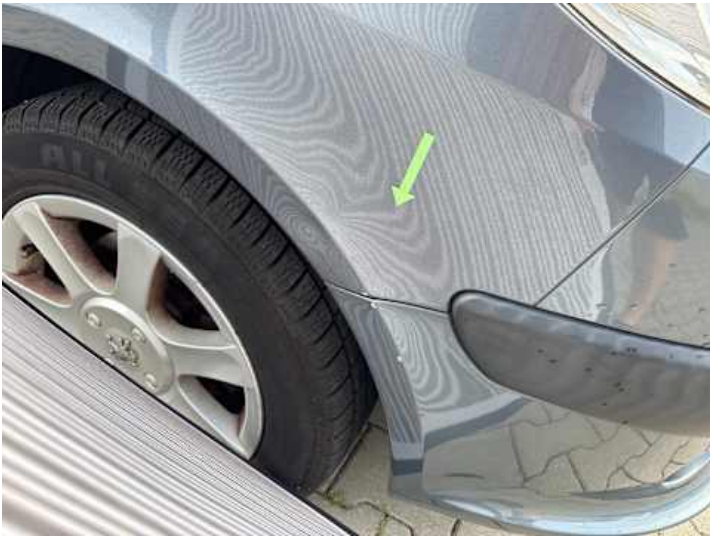
Kotflügel vorne rechts (Kratzer, Lackschaden, Delle)
