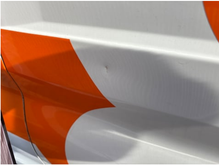
Seitenteil hinten links (Kratzer, Verformung)
