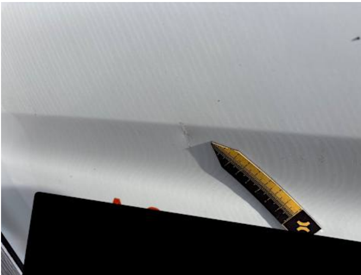
Fahrtür (Kratzer, Delle)
