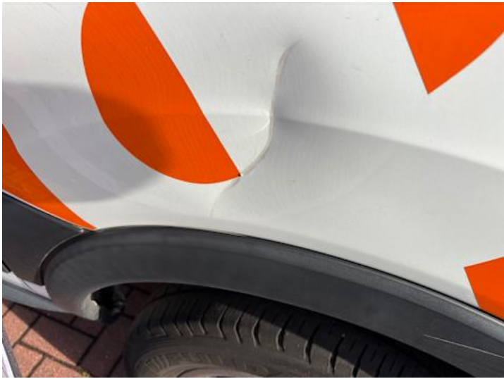
Seitenteil hinten links (Kratzer, Verformung)
