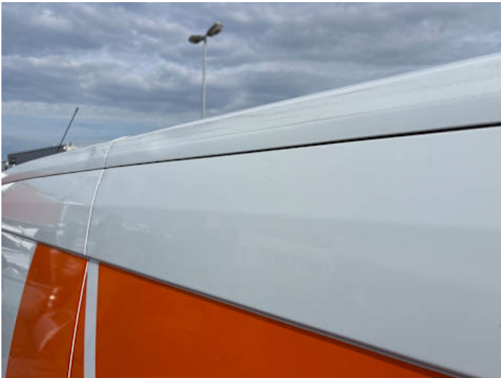
Dach (Kratzer, Verformung)
