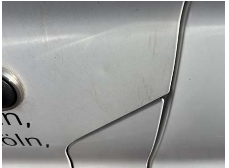
Fahrtür (Kratzer, Delle)
