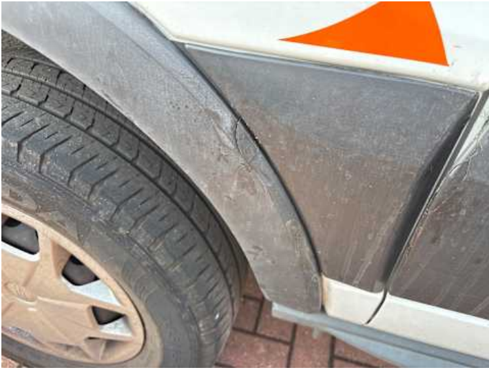
Seitenteil hinten rechts (Riss/Bruch, Kratzer)
