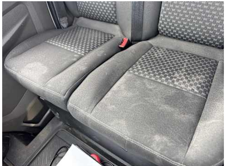
Innenraum (Brandloch, Verschmutzung)
