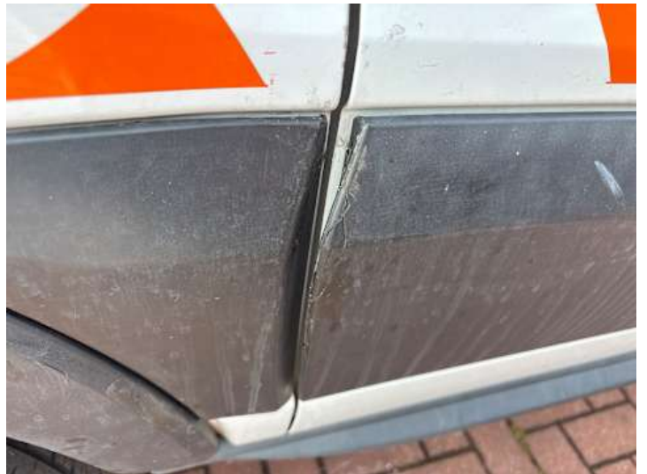
Türe hinten rechts (Riss/Bruch)
