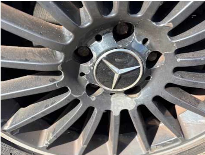
Rad (Kratzer, Riss/Bruch)
