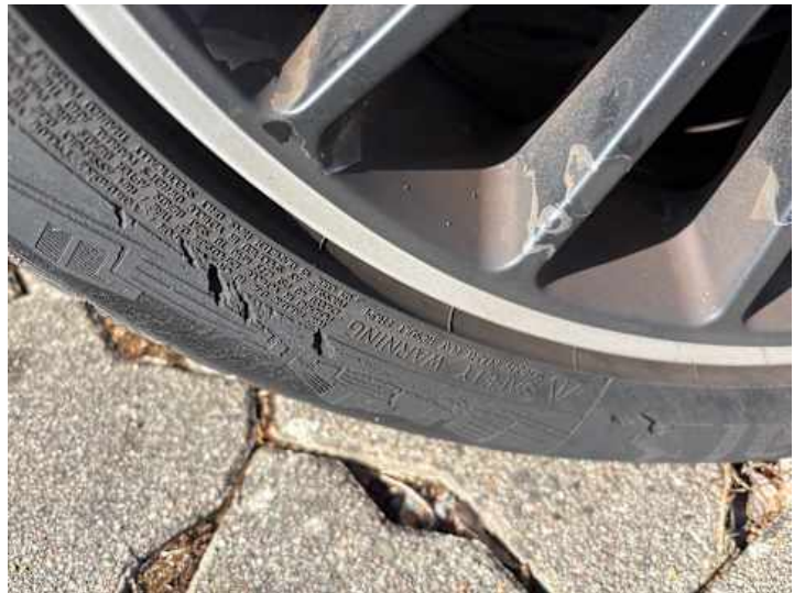
Rad (Kratzer, Riss/Bruch)
