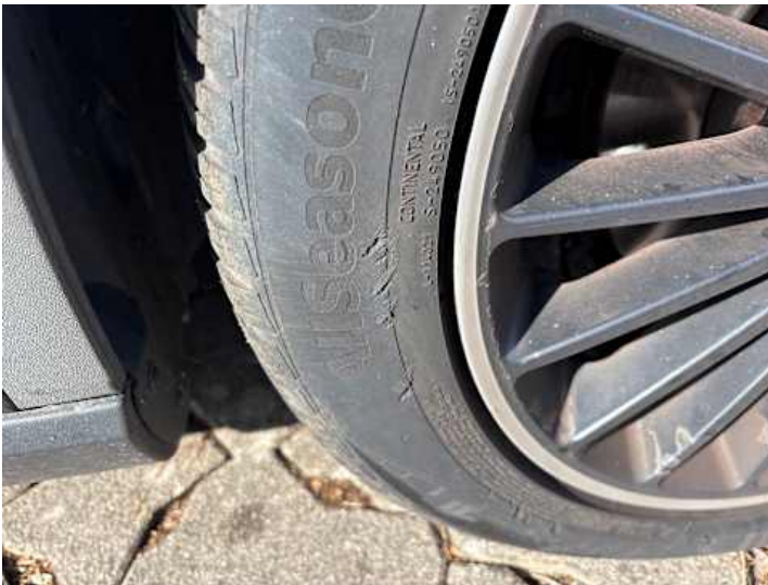
Rad (Kratzer, Riss/Bruch)
