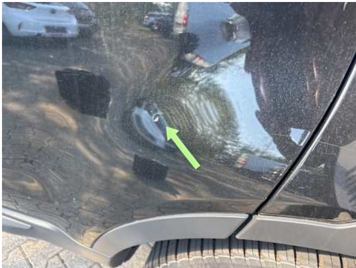
Türe hinten links (Kratzer)
