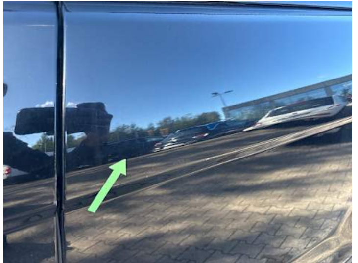
Türe hinten links (Kratzer)
