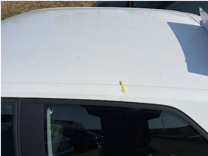
Dach (Unsachgemäß instand gesetzt)
