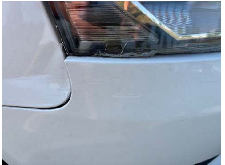
Stoßstange vorne (Unsachgemäß instand gesetzt)
