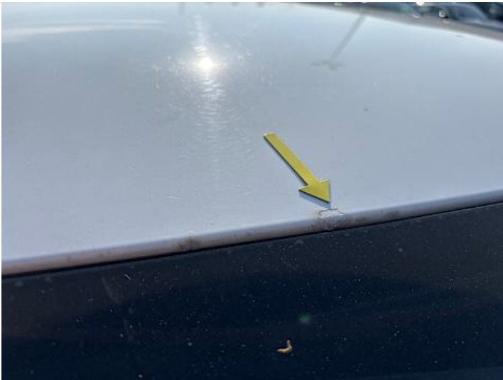
Dach (Unsachgemäß instand gesetzt)
