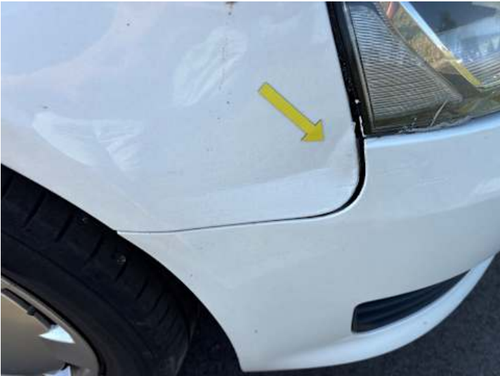
Kotflügel vorne rechts (Verformung, Kratzer, Unsachgemäß instand gesetzt)
