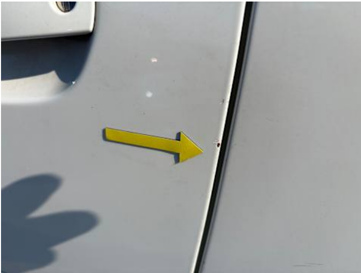
Fahrtür (Rost, Kratzer)
