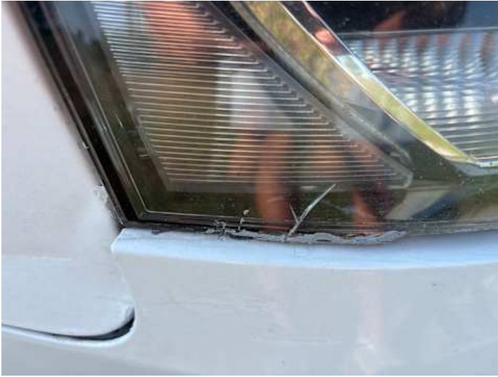
Scheinwerfer (rechts) (Riss/Bruch)
