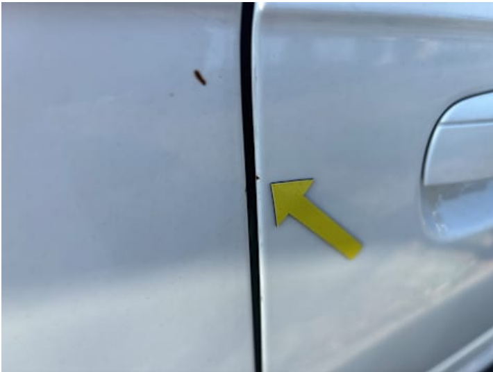
Beifahrtür (Kratzer, Rost)
