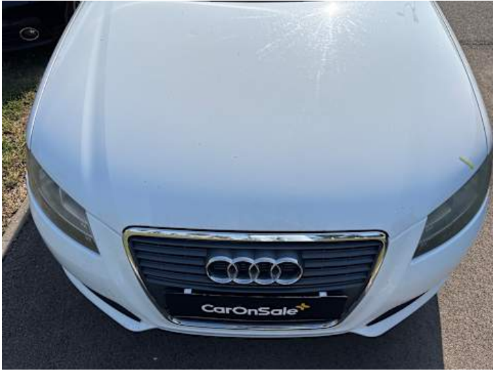
Motorhaube (Steinschlag, Rost)
