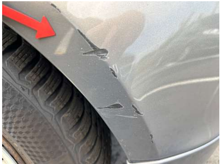
Stoßstange hinten (Kratzer, Verformung)
