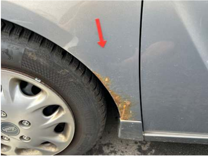
Kotflügel vorne links (Rost)
