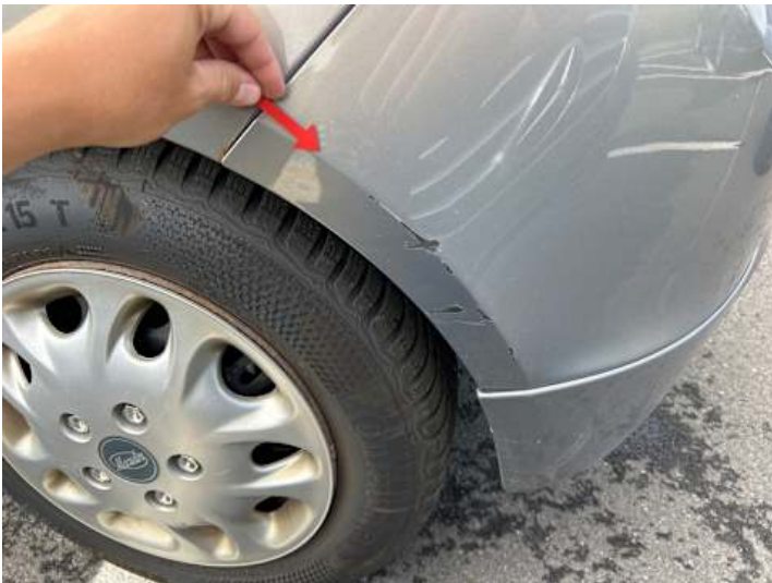
Stoßstange hinten (Kratzer, Verformung)
