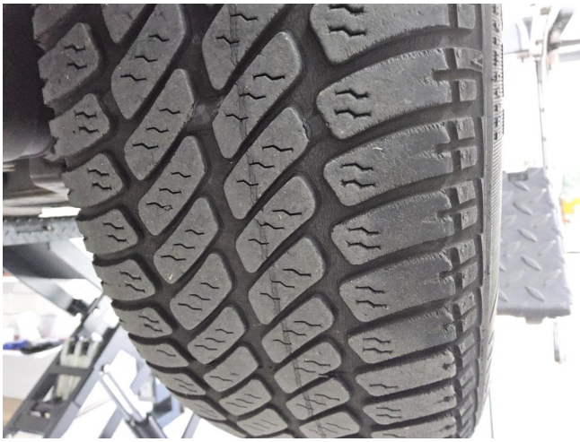
Reifen (Ganzjahres-Radsatz) - Vorderachse links - Ganzjahresreifen unter 4 mm, erneuern
