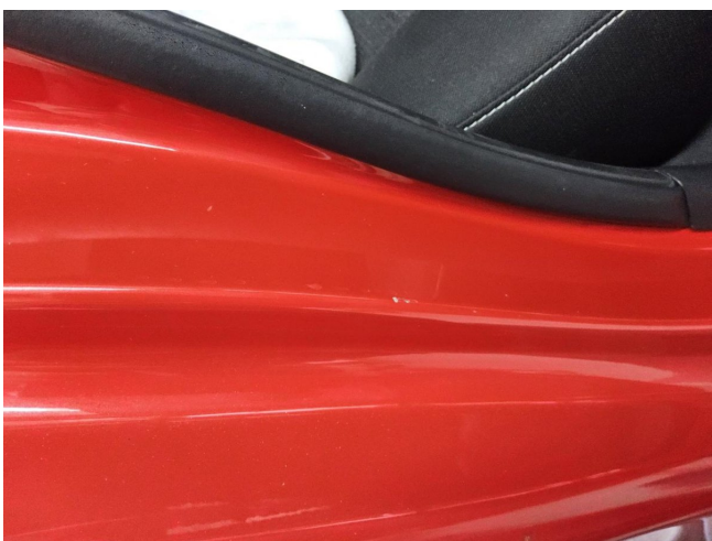
Einstieg HR zerkratzt smart repair
