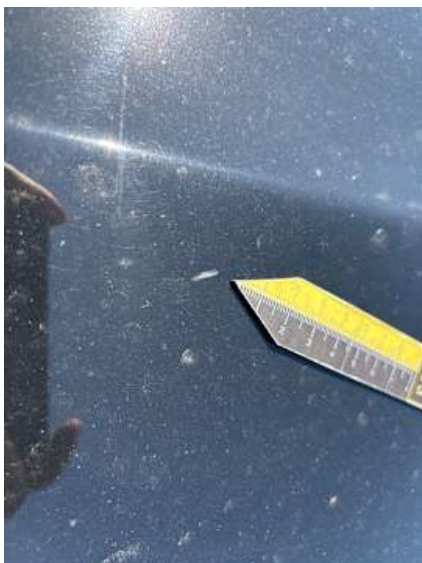
Motorhaube (Steinschlag, Unsachgemäß instand gesetzt)
