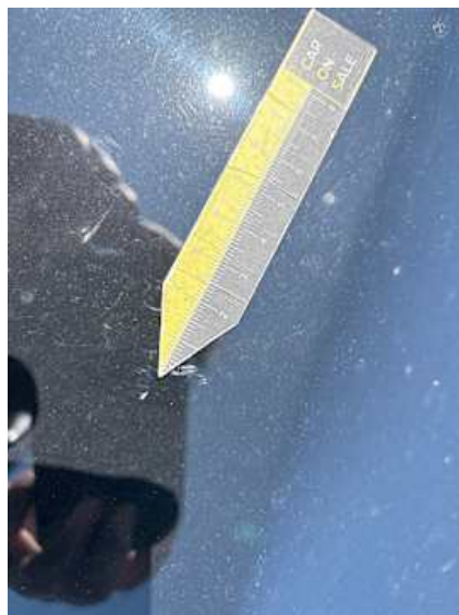
Motorhaube (Steinschlag, Unsachgemäß instand gesetzt)
