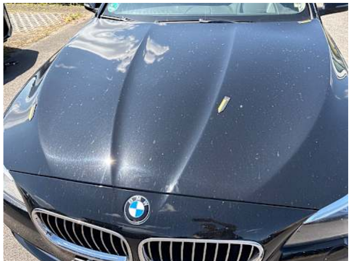
Motorhaube (Steinschlag, Unsachgemäß instand gesetzt)
