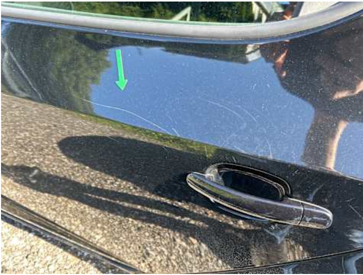
Türe hinten links (Kratzer)
