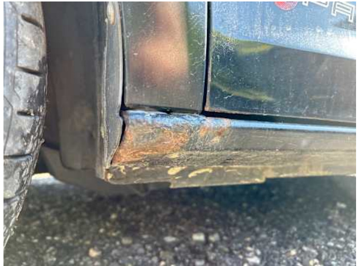
Schweller links (Rost)
