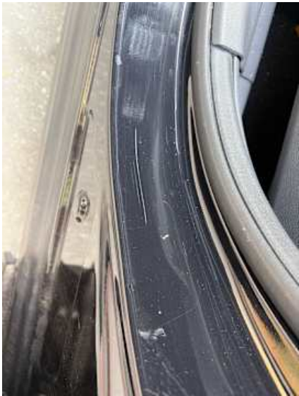
Fahrtür (Kratzer, Lackschaden, Delle)
