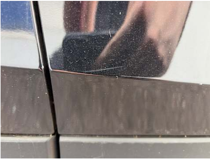
Beifahrertür (Kratzer, Lackschaden, Unsachgemäß instand gesetzt)
