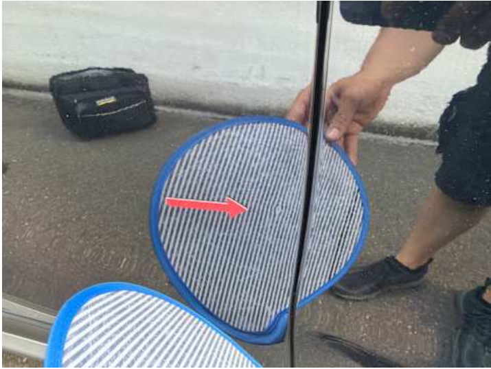
Türe hinten rechts (Delle, Kratzer)
