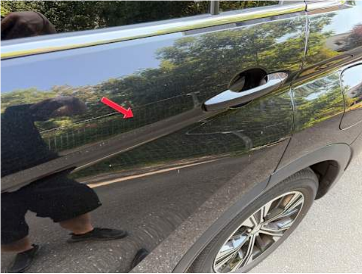
Türe hinten links (Kratzer, Lackschaden)
