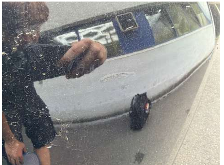
Stoßstange hinten (Lackschaden, Kratzer, Unsachgemäß instand gesetzt)
