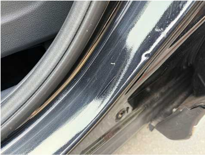
Fahrtür (Kratzer, Lackschaden, Delle)
