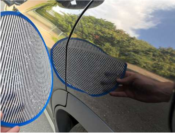
Seitenteil hinten links (Delle, Kratzer)
