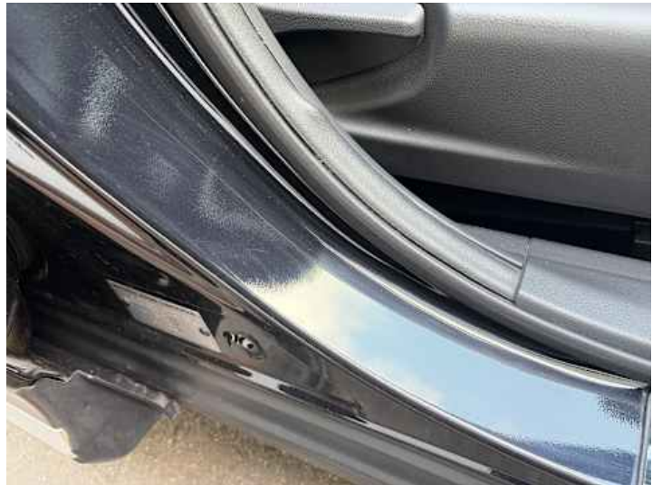
Beifahrertür (Kratzer, Lackschaden, Unsachgemäß instand gesetzt)
