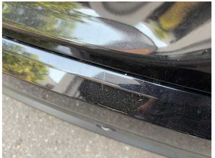
Stoßstange hinten (Lackschaden, Kratzer, Unsachgemäß instand gesetzt)
