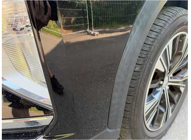
Stoßstange vorne (Kratzer, Lackschaden)
