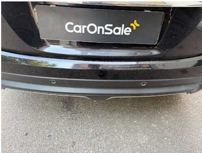
Stoßstange hinten (Lackschaden, Kratzer, Unsachgemäß instand gesetzt)
