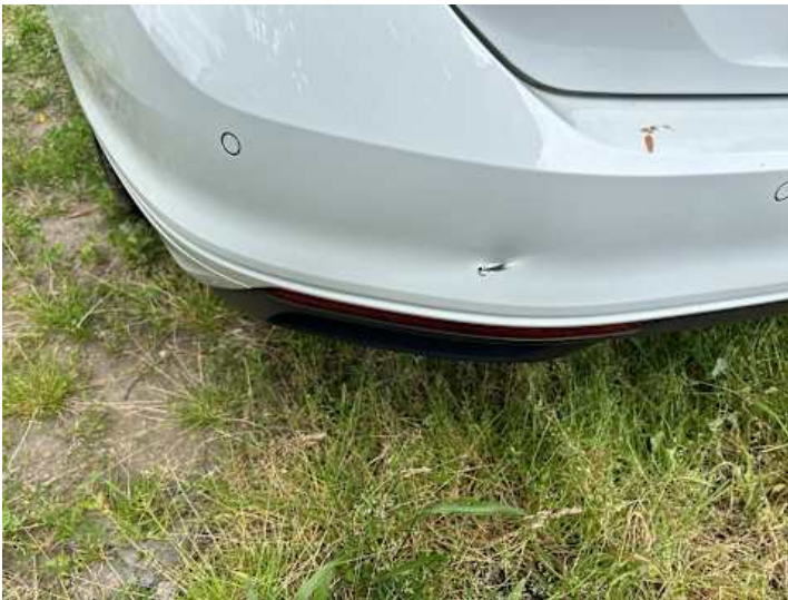
Stoßstange hinten (Kratzer, Verformung, Riss/Bruch)
