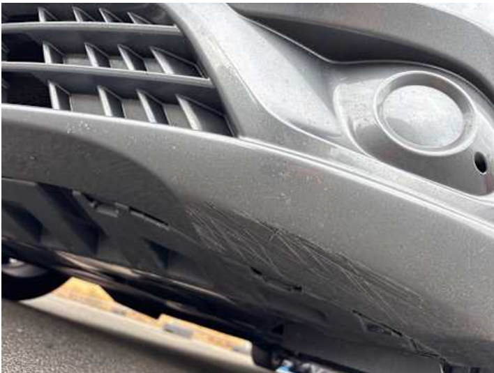
Stoßstange vorne (Kratzer, Lackschaden)
