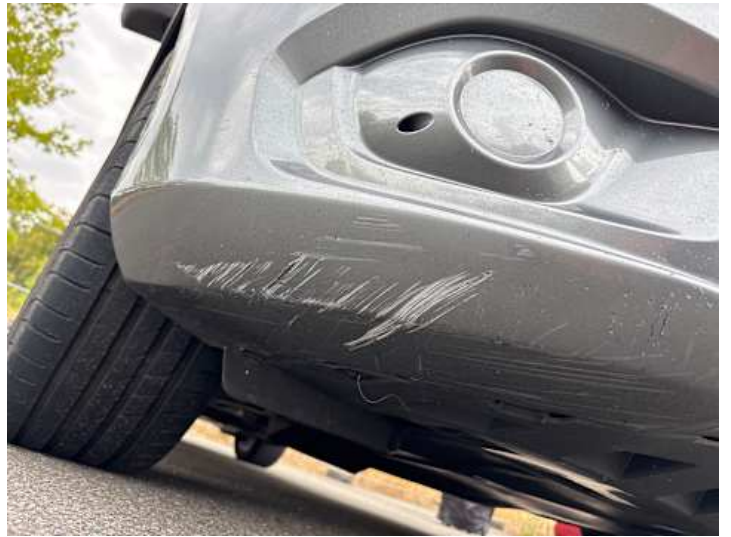
Stoßstange vorne (Kratzer, Lackschaden)
