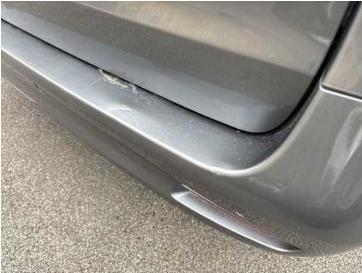
Stoßstange hinten (Kratzer, Lackschaden)
