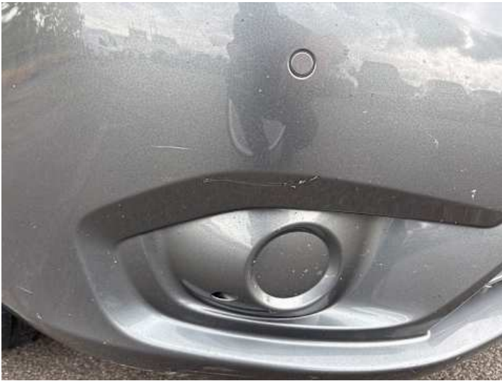
Stoßstange vorne (Kratzer, Lackschaden)
