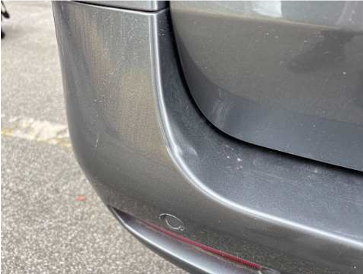
Stoßstange hinten (Kratzer, Lackschaden)
