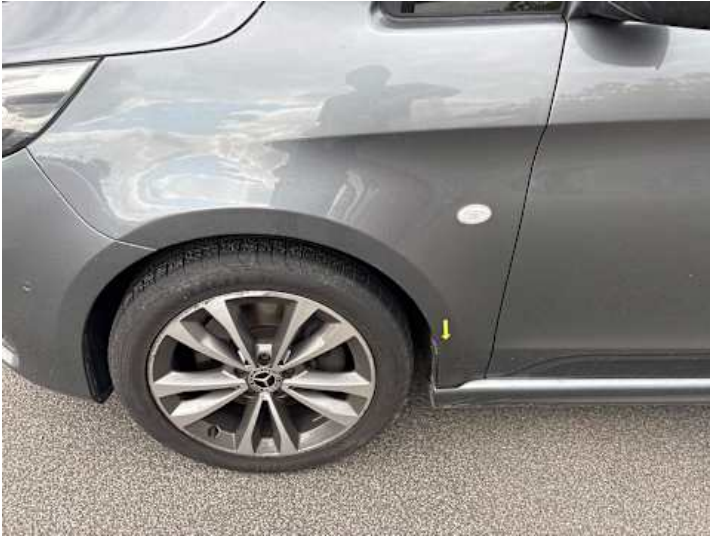
Kotflügel vorne links (Delle)
