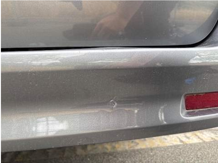
Stoßstange hinten (Kratzer, Lackschaden)
