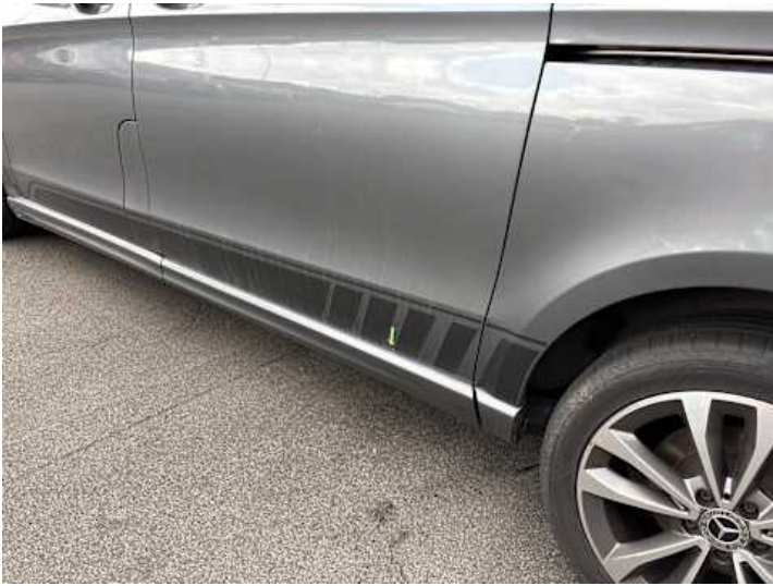
Schweller links (Kratzer)
