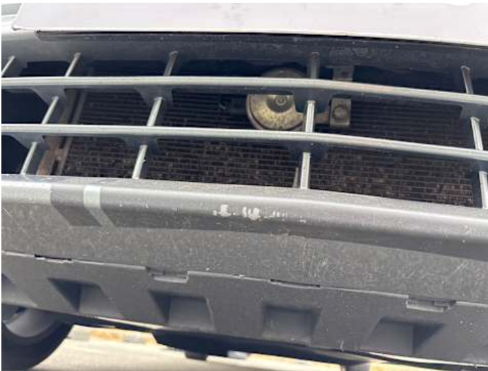
Stoßstange vorne (Kratzer, Lackschaden)
