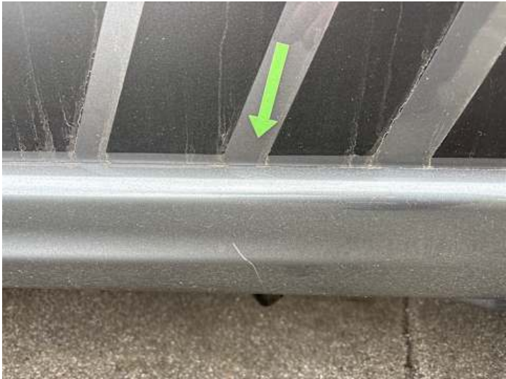
Schweller links (Kratzer)
