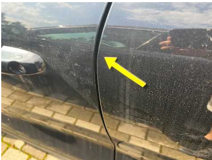
Türe hinten links (Kratzer)
