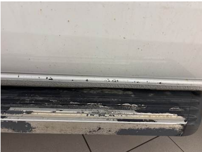
Schweller rechts (Lackschaden, Rost, Verformung)
