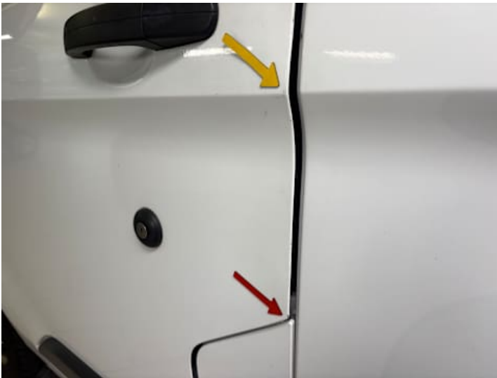
Fahrtür (Lackschaden, Rost)
