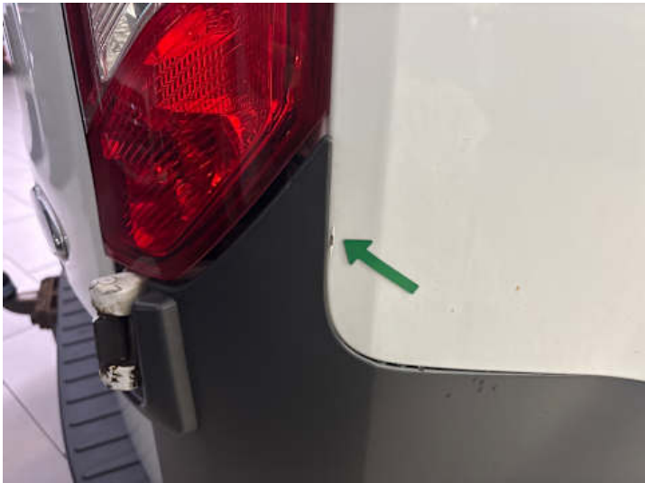
Seitenteil hinten rechts (Rost, Lackschaden)
