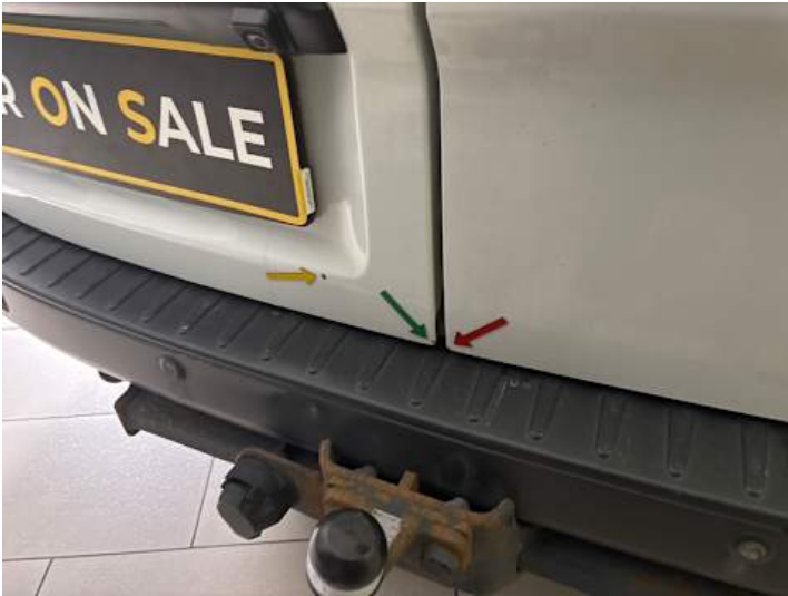
Heckklappe (Lackschaden, Rost, Unsachgemäß instand gesetzt)
