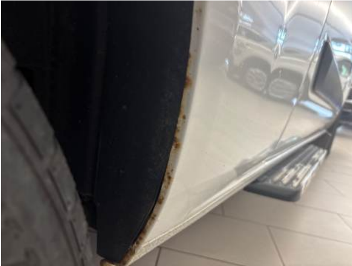
Seitenteil hinten rechts (Rost, Lackschaden)
