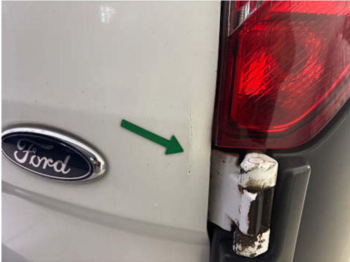
Heckklappe (Lackschaden, Rost, Unsachgemäß instand gesetzt)
