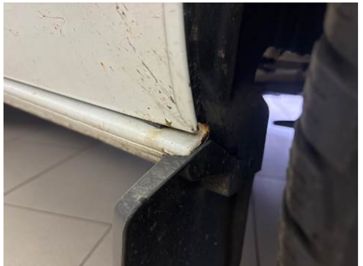
Schweller rechts (Lackschaden, Rost, Verformung)
