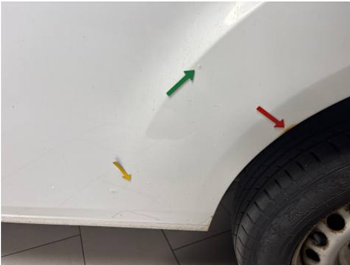
Seitenteil hinten links (Lackschaden, Rost)
