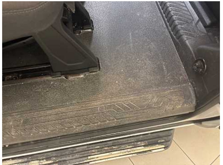
Innenraum (Verschmutzung, Kratzer)
