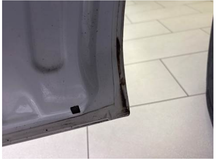
Fahrtür (Lackschaden, Rost)
