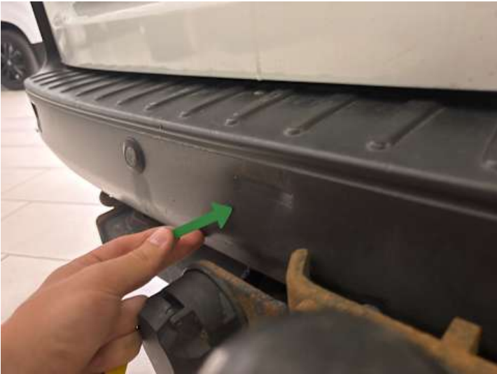
Stoßstange hinten (Kratzer, Anderer Schaden): Reflektor nicht vorhanden
