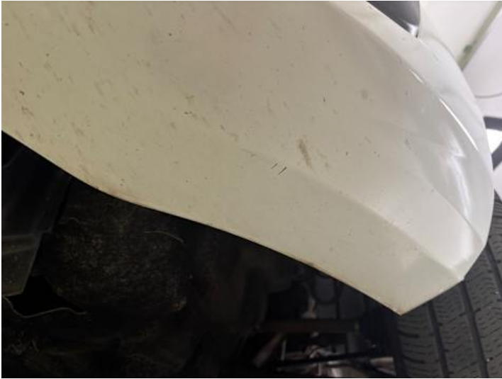
Stoßstange vorne (Kratzer, Lackschaden)
