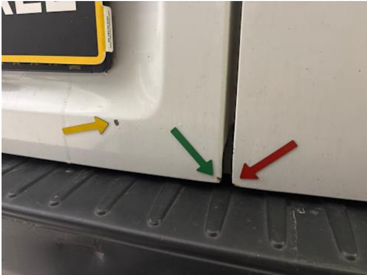
Heckklappe (Lackschaden, Rost, Unsachgemäß instand gesetzt)
