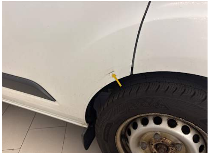
Beifahrtür (Kratzer, Lackschaden, Rost)
