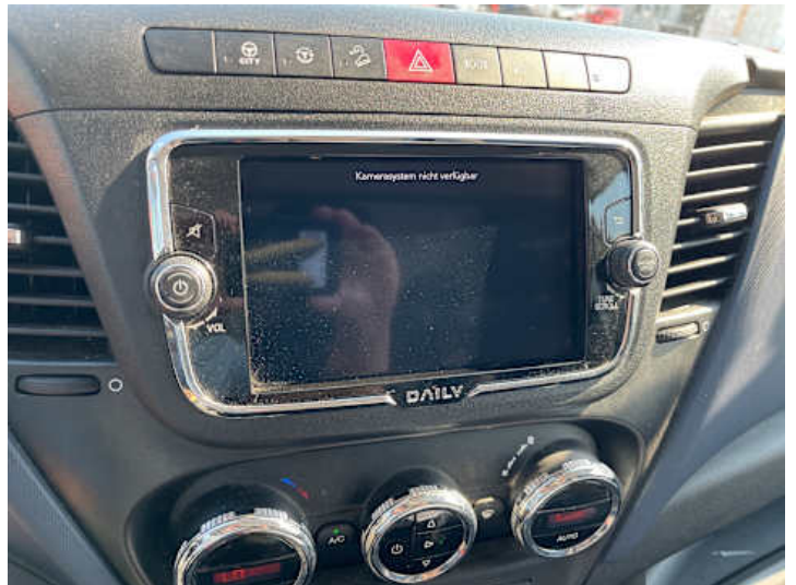
Innenraum (Anderer Schaden): Rückfahrkamera ohne Funktion
