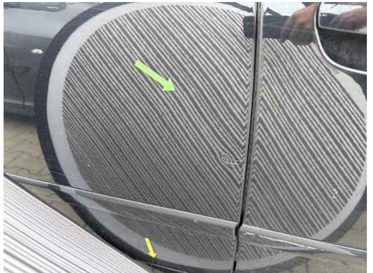
Türe hinten rechts (Kratzer, Delle)
