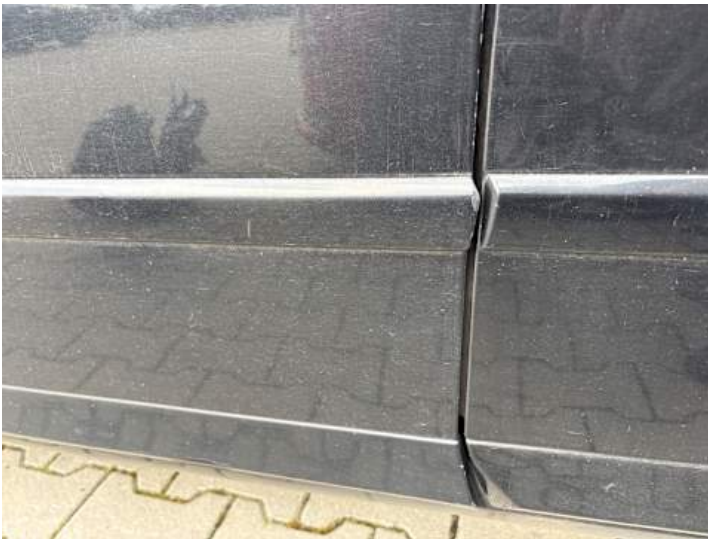
Fahrertür (Lackschaden, Kratzer)
