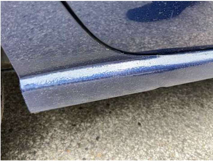
Schweller rechts (Lackschaden, Rost, Unsachgemäß instand gesetzt)
