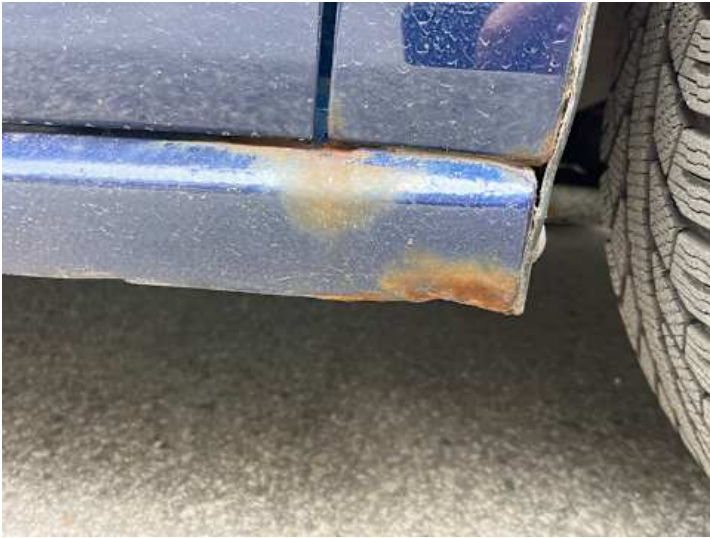
Schweller rechts (Lackschaden, Rost, Unsachgemäß instand gesetzt)
