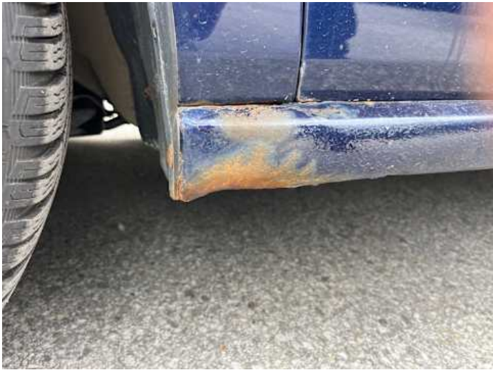
Schweller links (Lackschaden, Rost, Unsachgemäß instand gesetzt)
