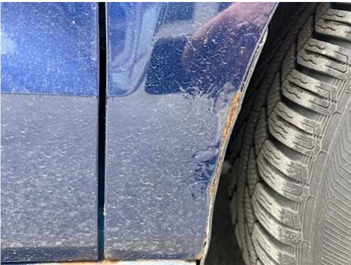
Kotflügel vorne rechts (Rost, Lackschaden)
