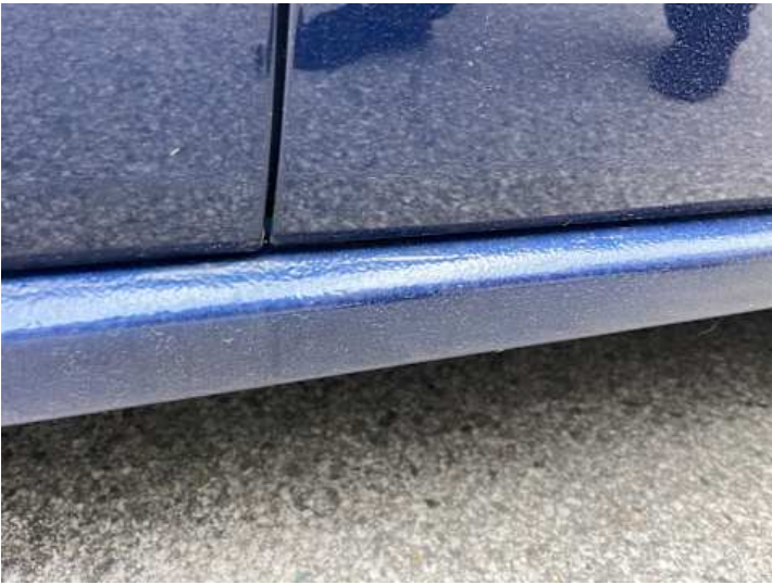
Schweller rechts (Lackschaden, Rost, Unsachgemäß instand gesetzt)
