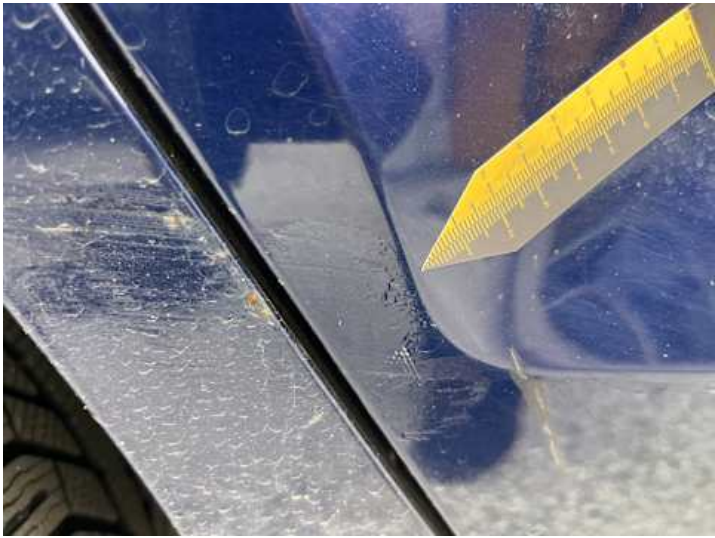
Türe hinten rechts (Lackschaden, Unsachgemäß instand gesetzt)
