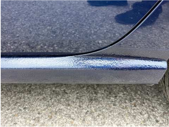
Schweller links (Lackschaden, Rost, Unsachgemäß instand gesetzt)
