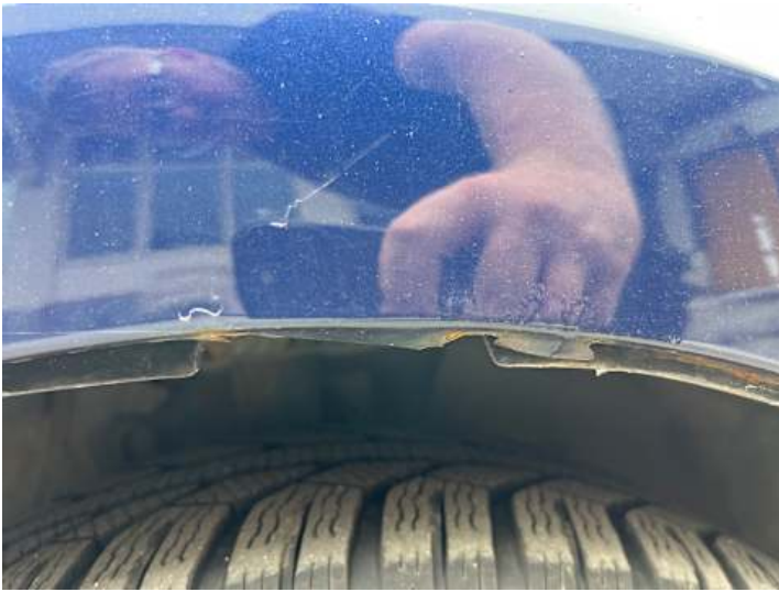
Kotflügel vorne rechts (Rost, Lackschaden)
