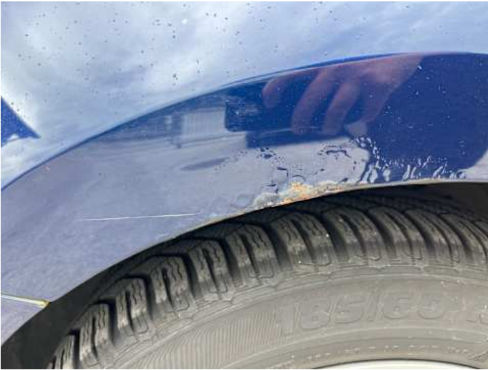
Kotflügel vorne links (Rost, Lackschaden)
