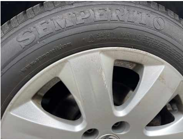
Rad (Kratzer, Kerben, Rost)
