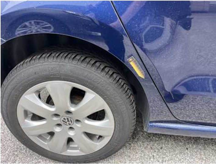
Seitenteil hinten rechts (Lackschaden, Unsachgemäß instand gesetzt)
