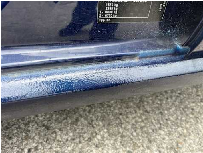
Schweller links (Lackschaden, Rost, Unsachgemäß instand gesetzt)
