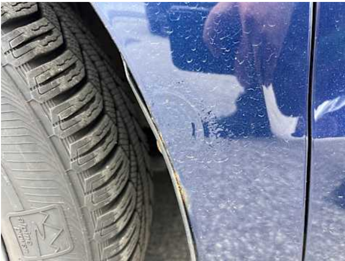
Kotflügel vorne links (Rost, Lackschaden)
