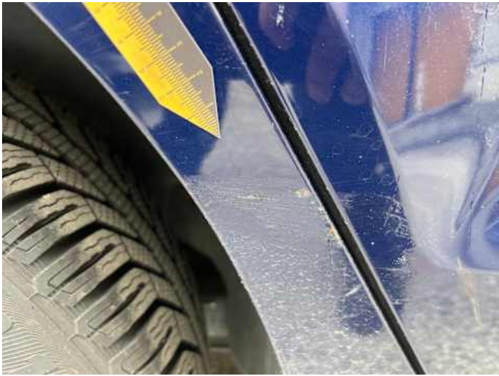
Seitenteil hinten rechts (Lackschaden, Unsachgemäß instand gesetzt)
