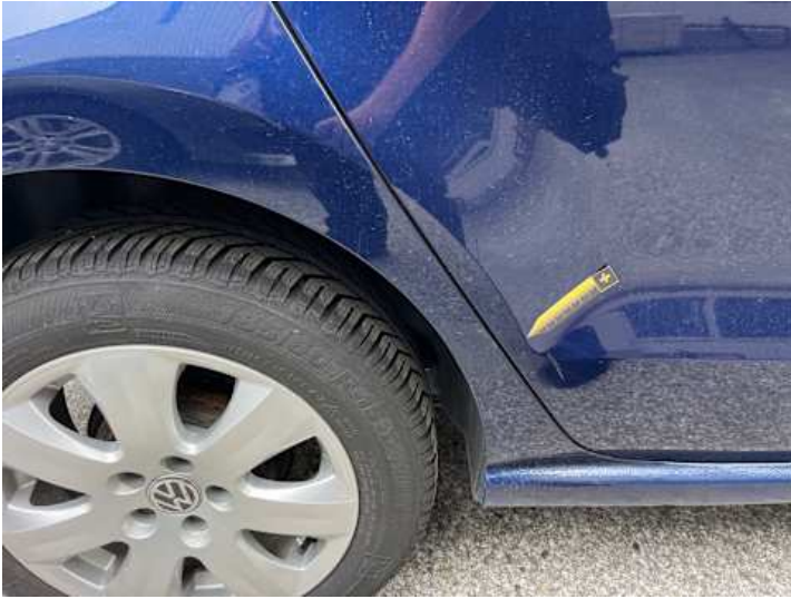
Türe hinten rechts (Lackschaden, Unsachgemäß instand gesetzt)
