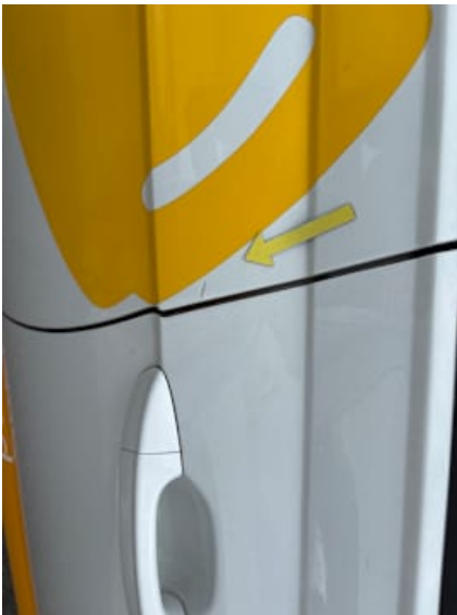
Türe hinten rechts (Kratzer)
