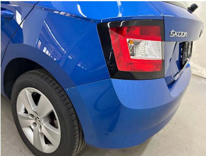
Stoßstange hinten (Anderer Schaden): Farbunterschied
