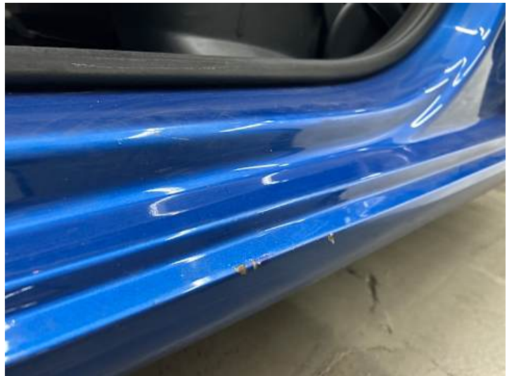
Schweller links (Delle, Kratzer, Rost)
